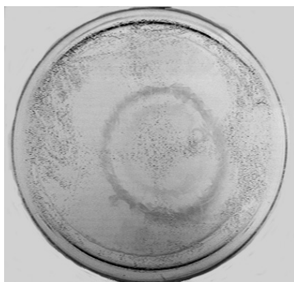
Prilog Slika 2. Ispitivanje aktivnosti etarskog ulja korena devesilja na rast laboratorijskog soja H. pylori agar-difuzionom metodom
