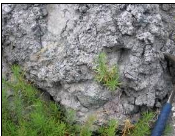
Slika 25: Svež hornblenda andezit s tragovima primarnog brečiranja sa polja 3
