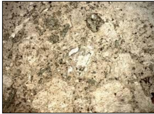
Slika 44: Relikti porfirne strukture u propilitisanom andezitu sa polja 9; zapaža se veći stepen alteracije plagioklasa nego na slici 43; ppl, horizontalna ivica snimka 6 mm
