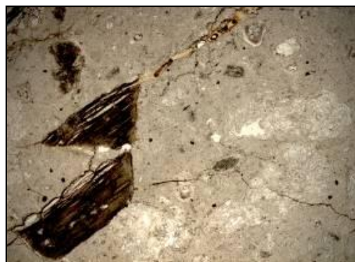
Slika 60: Andezit hipokristalasto-porfirske strukture, sa slabo deformisanim i hloritisanim fenokristalima biotita i delimično alterisanim fenokristalima plagioklasa sa polja 13, sklop-ppl, horizontalna ivica snimka 6 mm
