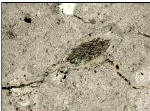
Sl. 59: Relikt fenokristala hornblende u delimično propilitisanom andezitu sa polja 13, hbl-ppl, horizontalna ivica snimka 1.5 mm
