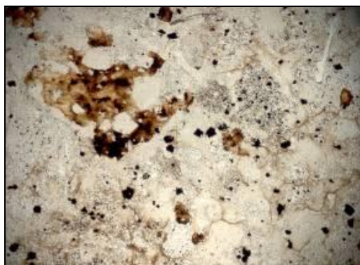
Slika 85: a) Fino dispergovani rudni minerali u masi potpuno kaolinisanog andezita; u gornjem levom delu fotografije zapažaju se nepravilni agregati hlorita, koji su najverovatnije nastali transformacijom nekadašnjih bojenih minerala u andezitu, polje 9.1., ppl, horizontalna ivica snimka 6 mm, b) Slika 85a pod ukrštenim nikolima.
