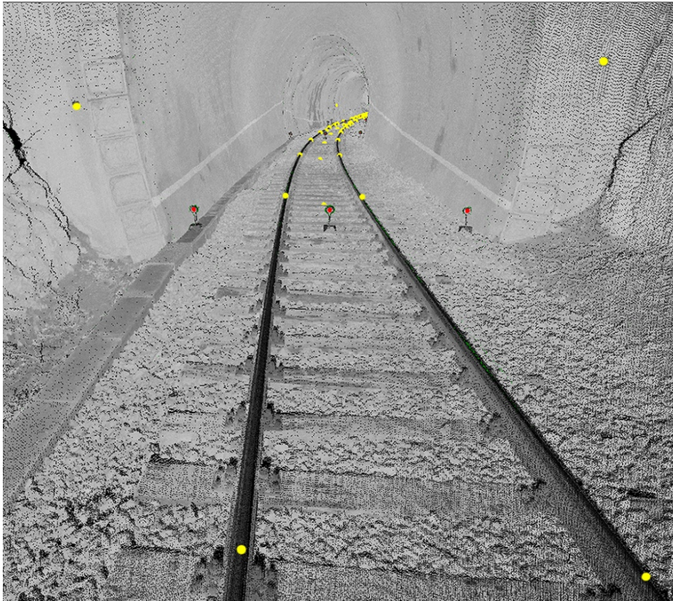
Slika 7-13 Dodatna kontrola georeferenciranja. Snimljene pozicije šina i signalisane tačke kontrolne geodetske mreže su kontrolisane vizuelno, nezavisno od modela prostorne transformacije
