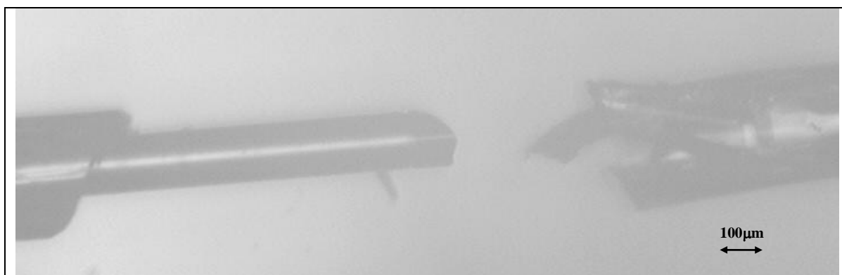
Sl.3.95. Mikrofotografija osnovnog optičkog vlakna, nakon kidanja
