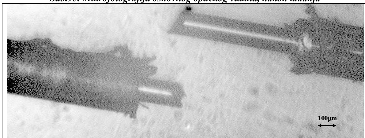
Sl.3.96. Mikrofotografija optičkog vlakna sa kompozitnom prevlakom (EVA sa 10,7 zap. Ba-ferita) nakon kidanja
