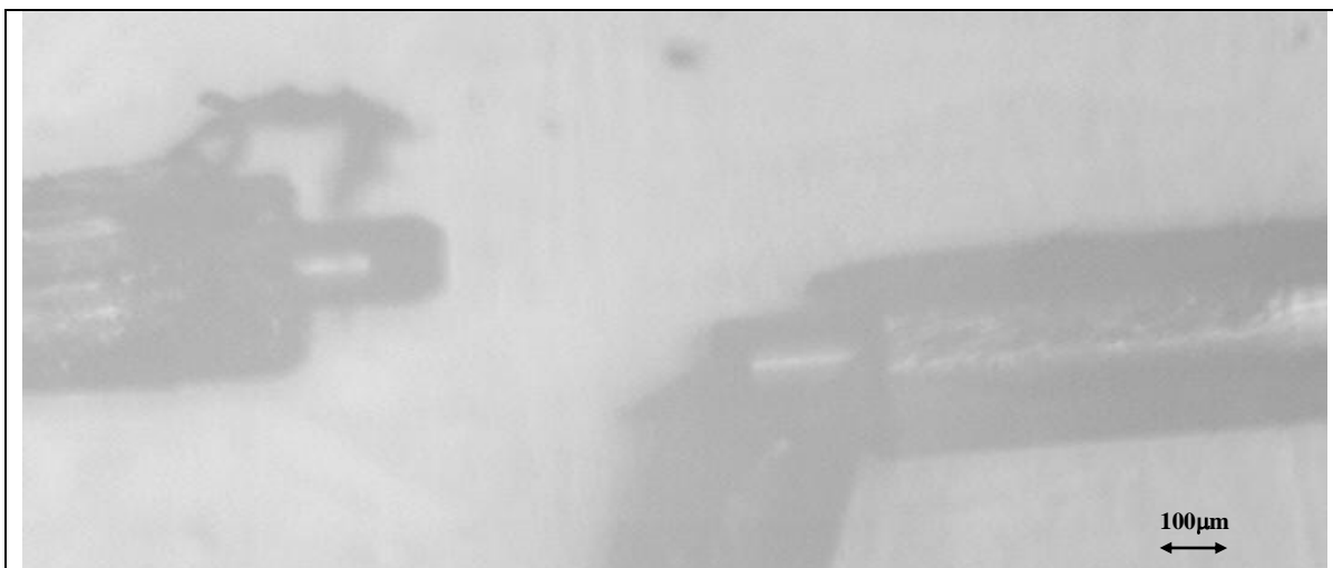
Sl.3.97. Mikrofotografija optičkog vlakna sa kompozitnom prevlakom (EVA sa 10,7 zap. SmCo_5 ) nakon kidanja
