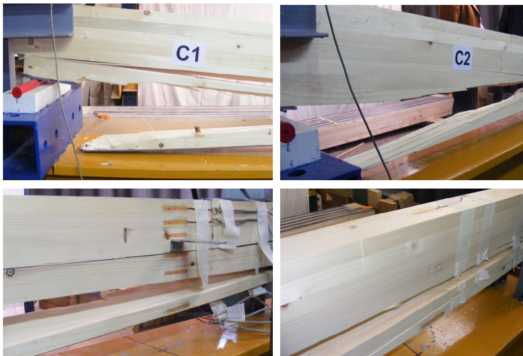
Slika 6.13 - Karakterističan lom ojačanih nosača Serije C (nosači C1 i C2)
