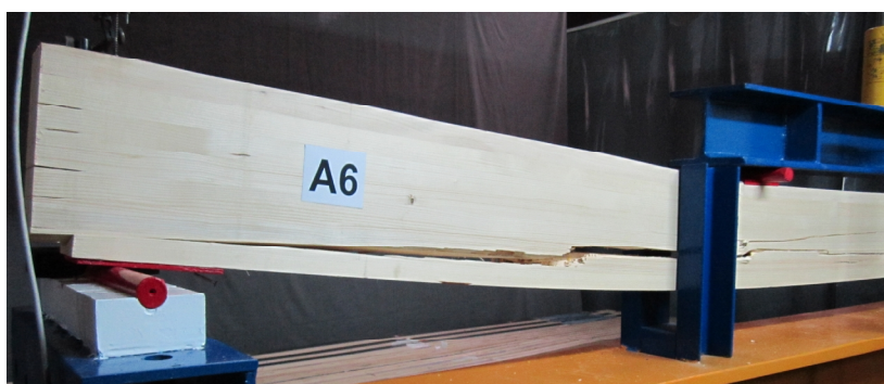
Slika 6.5 - Lom neojačanog nosača usled smicanja (nosač A6)
