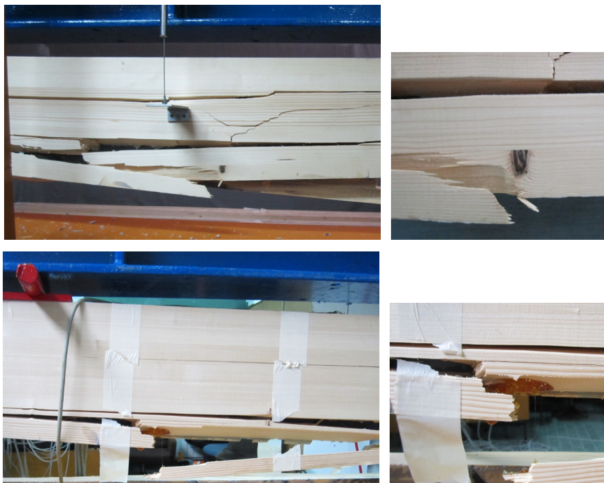
Slika 6.21 - Karakterističan lom ojačanih nosača Serije E (nosači E1 i E4)
