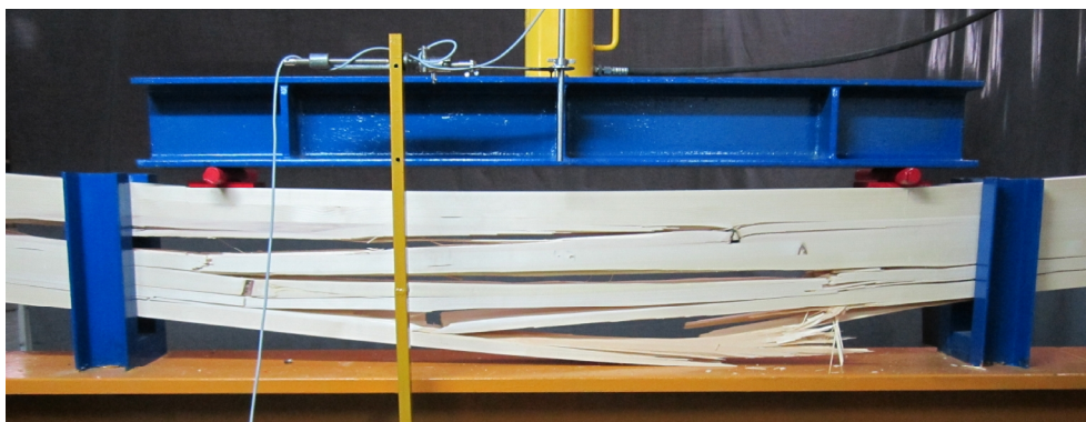
Slika 6.2 - Karakterističan lom neojačanih nosača (nosač A8)
