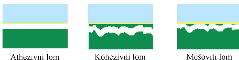
Slika 3.6 - Poređenje između različitih tipova loma [22]
