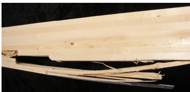
Slika 6.9 - Lom usled smicanja (nosač B5)
