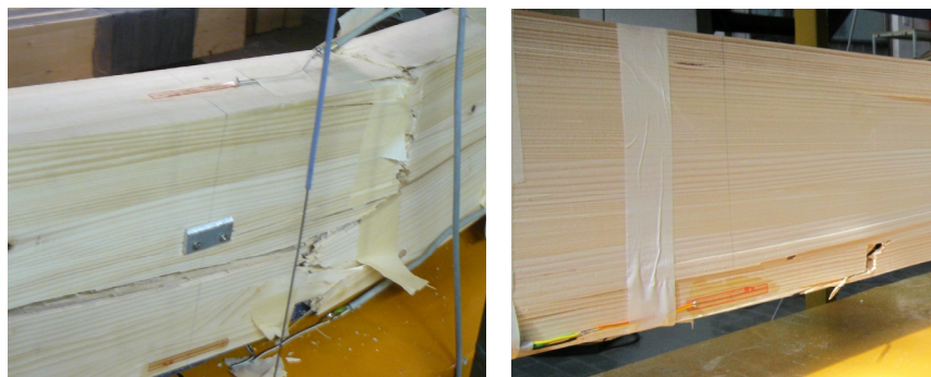
Slika 6.17 - Karakterističan lom ojačanih nosača Serije D (nosači D3 i D4)
