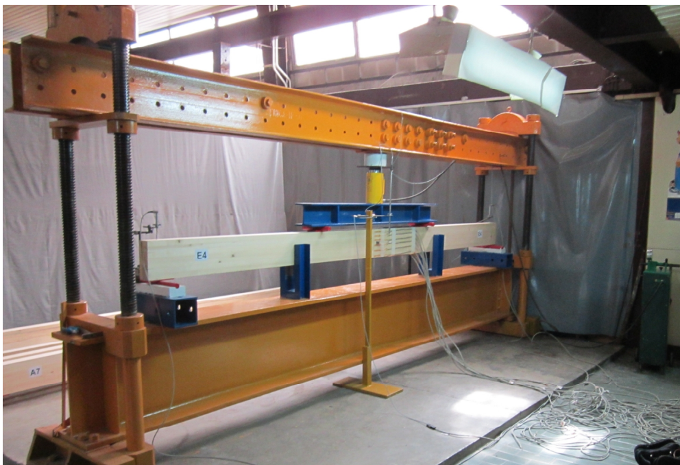
Slika 5.34 - Nosač u ramu za ispitivanje
