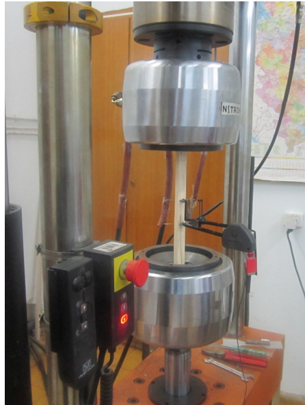
Slika 5.1 - Ispitivanje uzoraka drveta na zatezanje paralelno vlaknima
