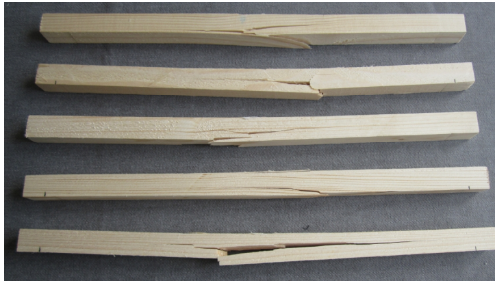
Slika 5.9 - Tipičan oblik loma drvenih uzoraka pri savijanju
