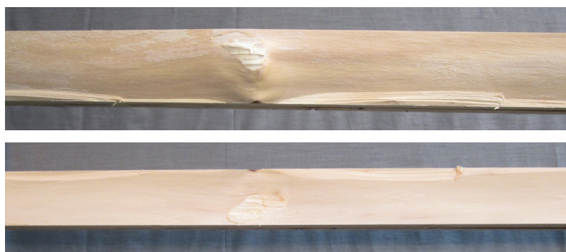
Slika 6.27 - Odvajanje drvne mase između godova (nosač F3)
