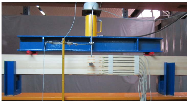
Slika 5.35 - Srednji deo nosača sa položajem elemenata za nošenje opterećenja
