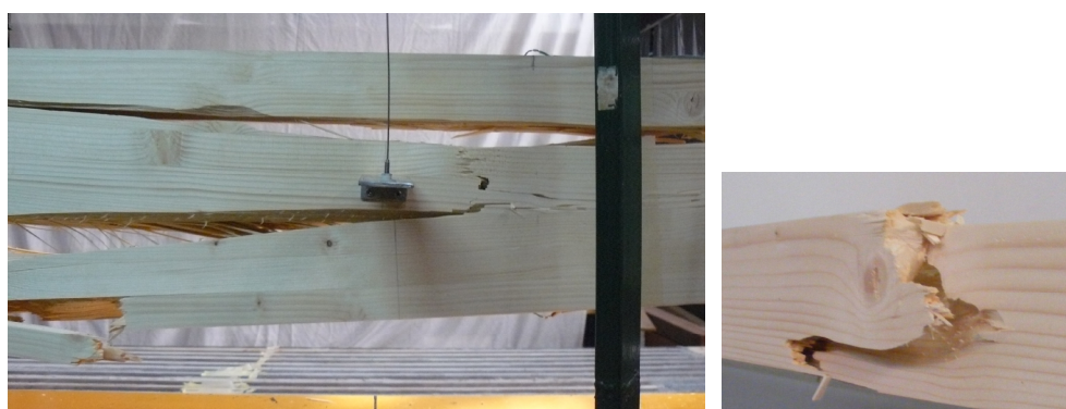
Slika 6.3 - Lom neojačanog nosača usled zatezanja na mestu kvрге (nosač A2)
