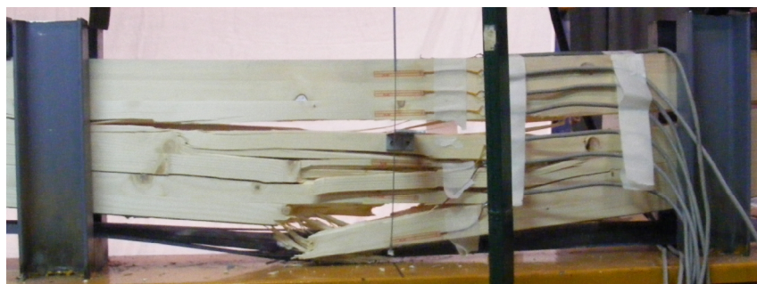
Slika 6.11 - Lom pri kome je došlo do potpunog odvajanja karbonske trake (nosač B1)
