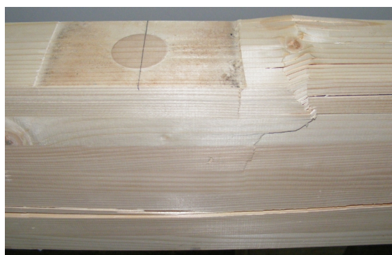
Slika 6.15 - Lokalni lom na mestu unošenja sile (nosač C2)
