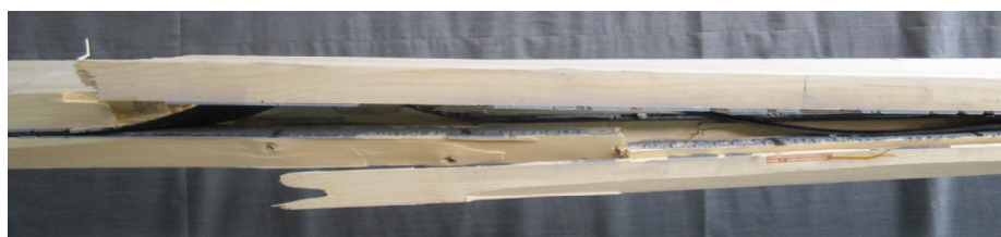
Slika 6.23 - Lom pri kome je došlo do odvajanja karbonske trake (nosač E2)
