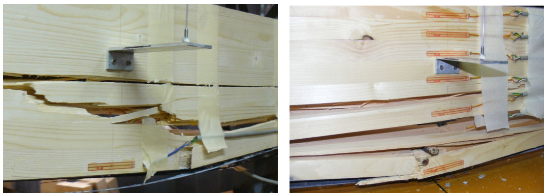
Slika 6.7 - Karakterističan lom ojačanih nosača Serije B (nosači B9 i B4)
