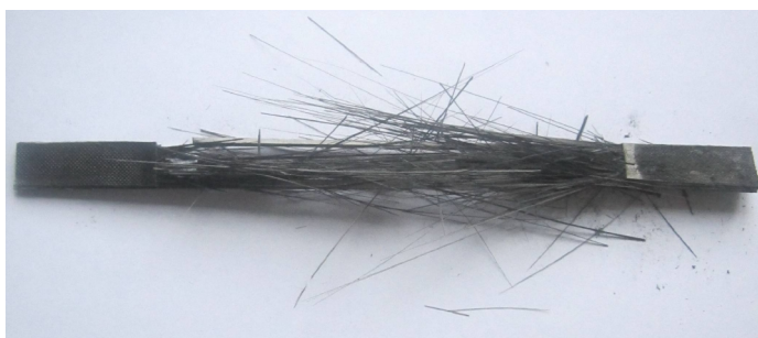
5.16 - Tipičan oblik loma uzoraka karbonske trake pri zatezanju
