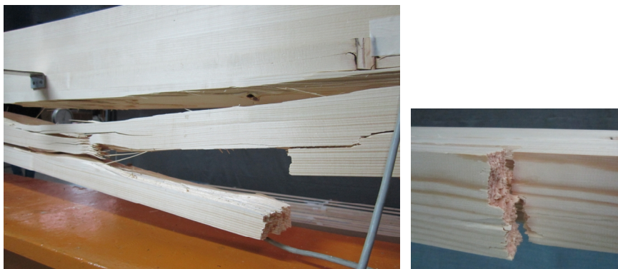
Slika 6.4 - Lom neojačanog nosača usled zatezanja po čistom drvetu (nosač A4)
