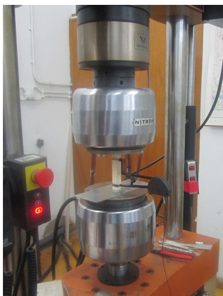
Slika 5.4 - Ispitivanje uzoraka drveta na pritisak paralelno vlaknima
