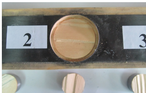
Slika 5.22 - Tipičan oblik loma pri ispitivanju spoja drvo-karbonska traka pull-off testom
