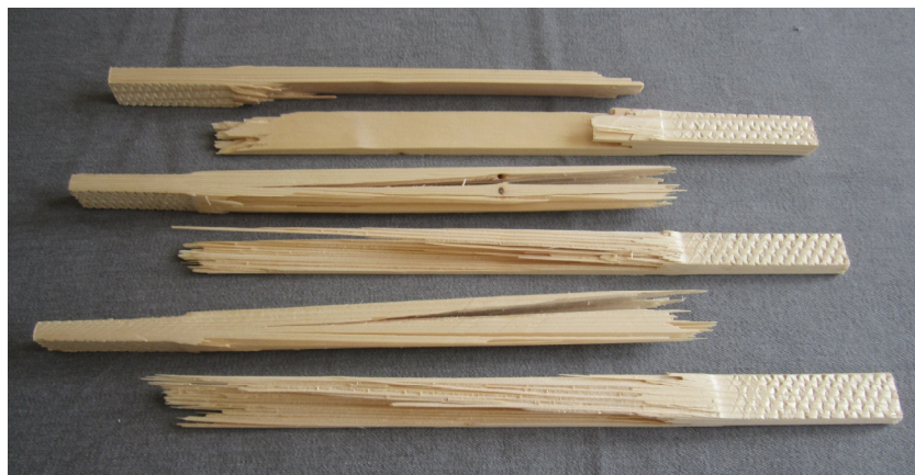
Slika 5.3 - Tipičan oblik loma drvenih uzoraka pri zatezanju paralelno vlaknima
