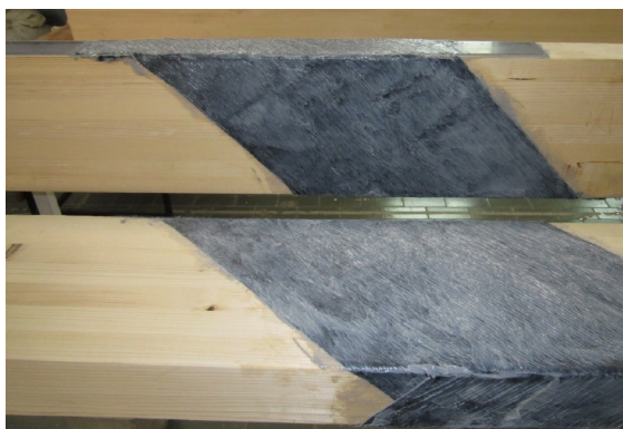
Slika 5.32 - Izgled krajeva nosača dodatno ojačanih koso postavljenim karbonskim tkaninama
