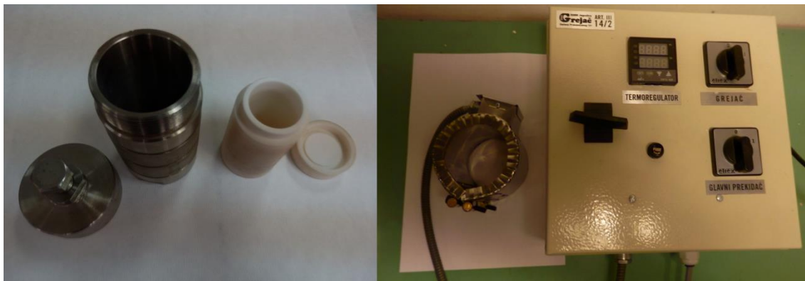
Slika 3.5. Autoklav sa teflonskim uloškom i grejač
