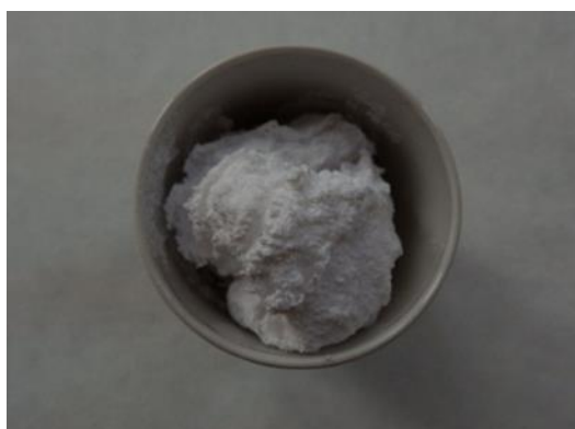
Slika 3.2. Uzorak u tigliu dobijen metodom polimerno-kompleksnog rastvora
