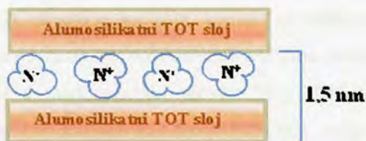
Slika 2.10. Shematski dijagram formiranja “pilara” od TMA jona u prostoru međusloja smektita.
