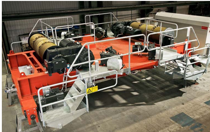
Slika. 1.7. Kolica sa elektropogonom mehanizma kretanja i mehanizma dizanja
