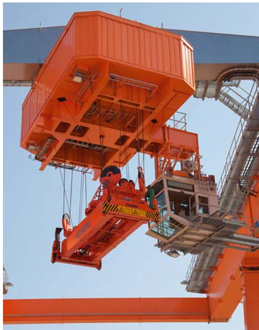
Slika. 1.8. Obrtna platforma u sistemu kolica sa hvatačem kontejnera
