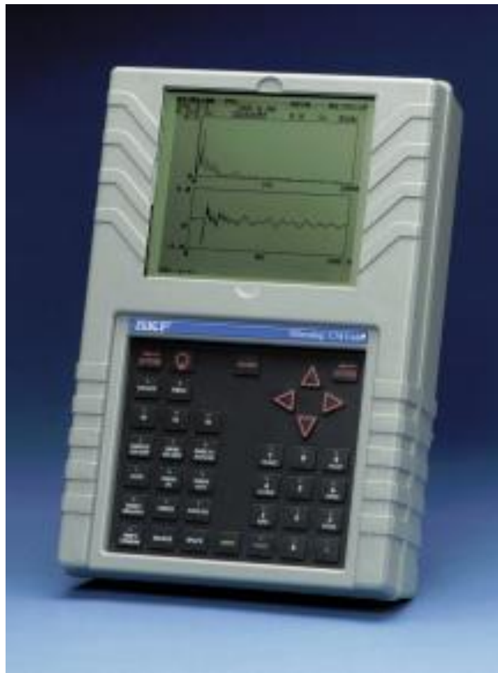
Slika 6.9 – Microlog CMVA 60, SKF (Vibroanalizator, data kolektor)
