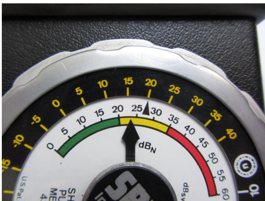
Slika 6.12 – Ocena stanja ležaja pomoću SPM 43A
