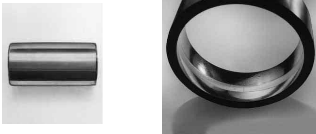
Slika 3.17 – Habanje ležaja usled neadekvatnog podmazivanja [4]
