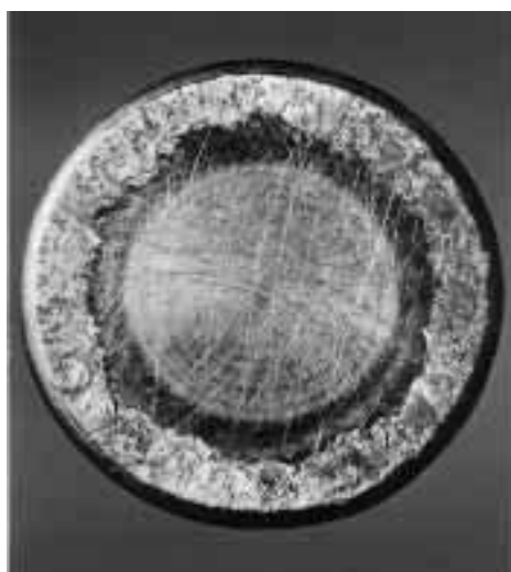
Slika 3.25 – Oštećenje valjkastog ležaja usled dejstva velikih aksijalnih sila i nekvalitetnog podmazivanja [4]
