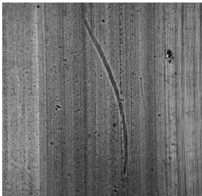
Slika 3.23 – Oštećenje ležaja usled prisustva spoljnih čestica [4]
