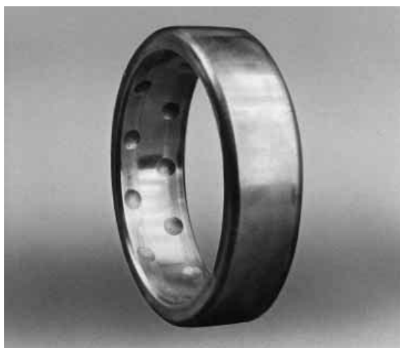
Slika 3.18 – Oštećenje kugličnog ležaja usled povećanih vibracijama [4]
