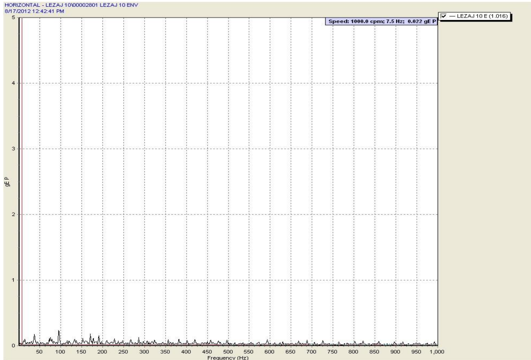
Slika 6.44 – Envelopa ubrzanja na ležaju broj 10
