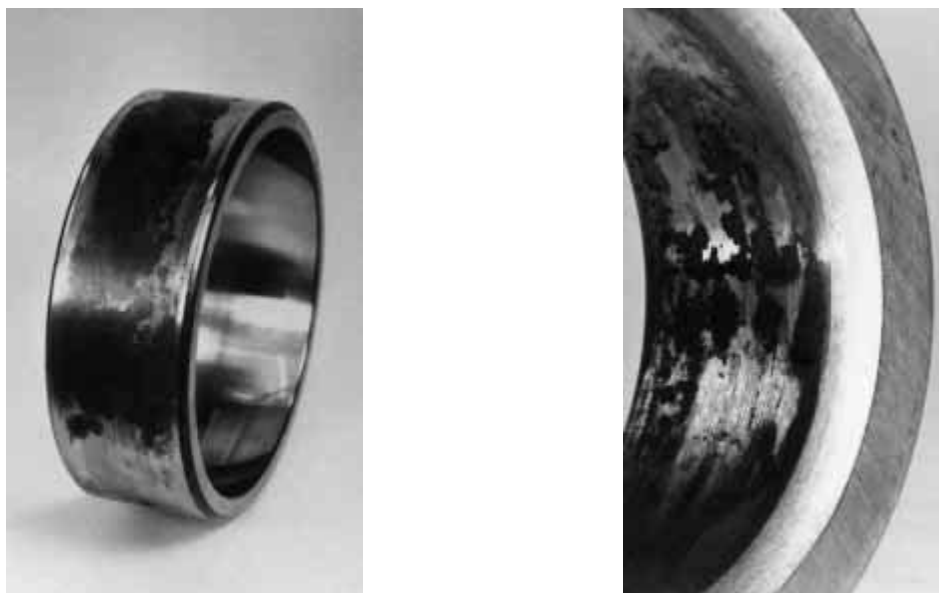
Slika 3.29 –Korozija ležaja usled trenja (Fretting) [4]
