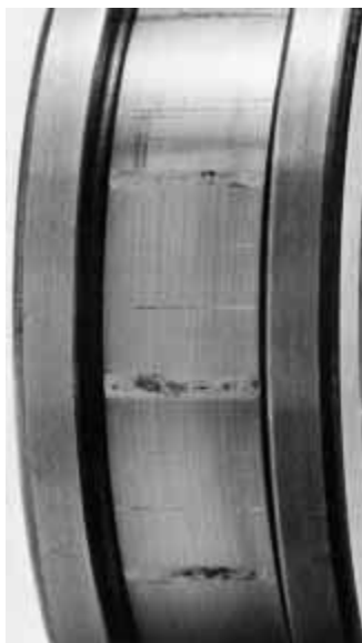
Slika 3.19 – Oštećenje valjkastog ležaja izazvano povećanim vibracijama
