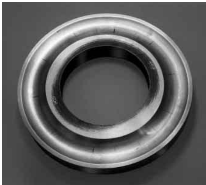
Slika 3.22 – Brazde na aksijalnom ležaju [4]
