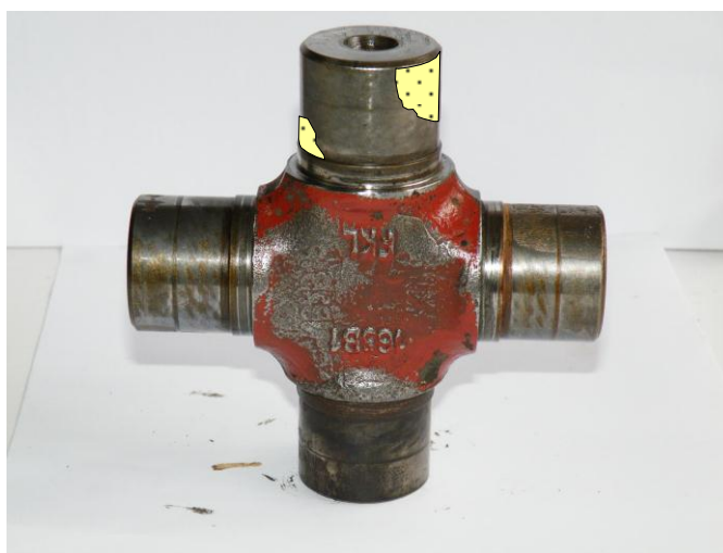
Слика 6.2 Позиција настанка контактних оштећења – разарања површине услед замора унакрсно распоређених на рукавцу
