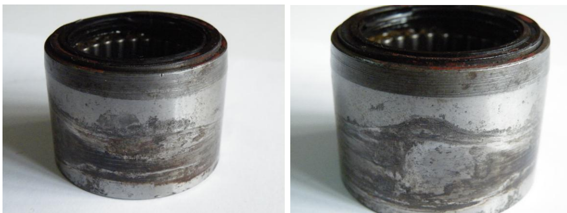
Слика 6.6. Оштећења на шољици лежаја услед фретинг корозије
