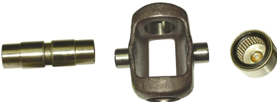
Слика 8. Крстасте осовине и шочице крста: а) ТИП 1, б) ТИП 2, в) ТИП 3 и г) ТИП 4
