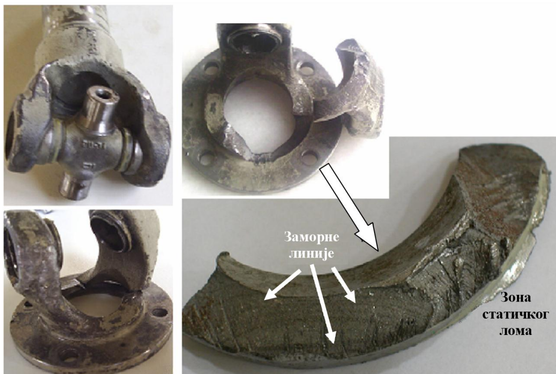
Слика 6.9 Изглед виљушке Кардановог зглоба након запреминског разарања
