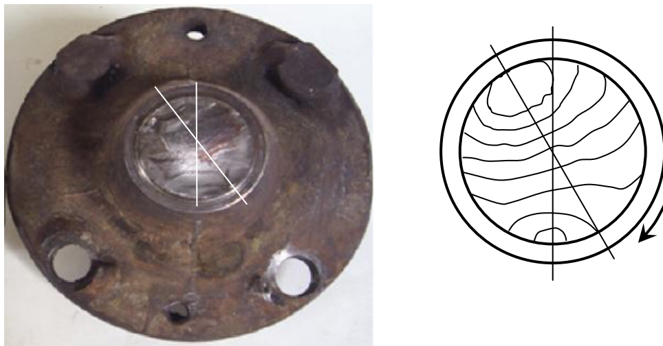
Слика 6.12 Преломна површина вратила упоређена са мапом из ASM приручника фрактографије [85]
