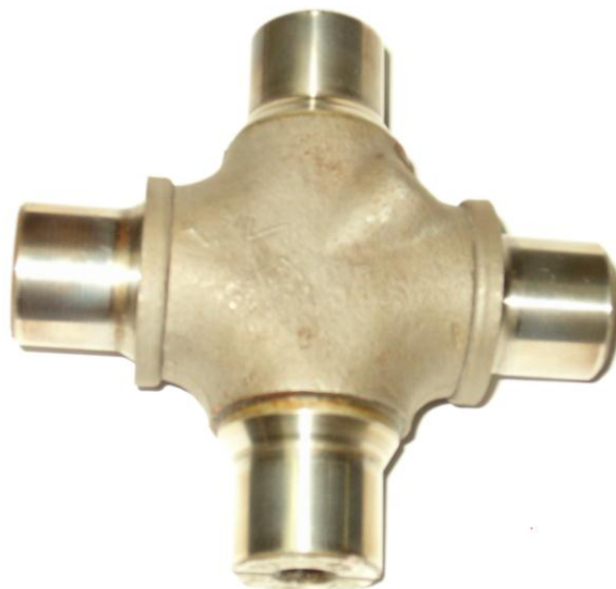
Слика 32. Изглед крстасте спојнице Кардановог вратила ТИП 1 након испитивања
