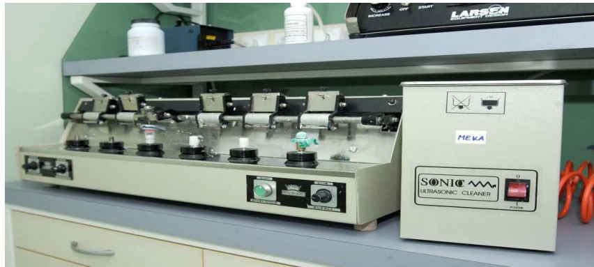
Slika 5.30. Viševretna mašina za poliranje ( preuzeto iz [79] )
