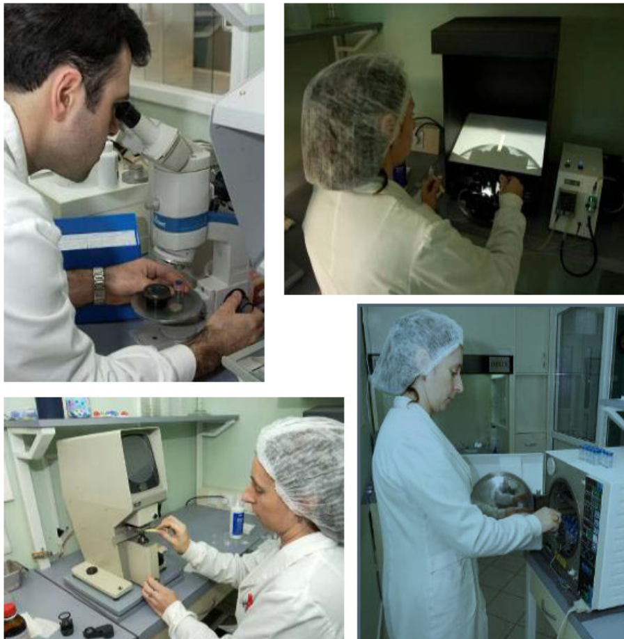
Slika 5.31. Radijuskop (gore levo), šedograf (gore desno), fokometar (dole levo) i parna sterilizacija sočiva (dole desno) ( preuzeto iz [79] )
