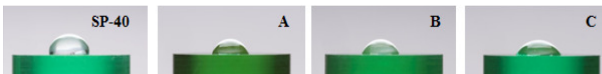
Slika 6.6. Ugao vlaženja – materijal u obliku dugmeta
