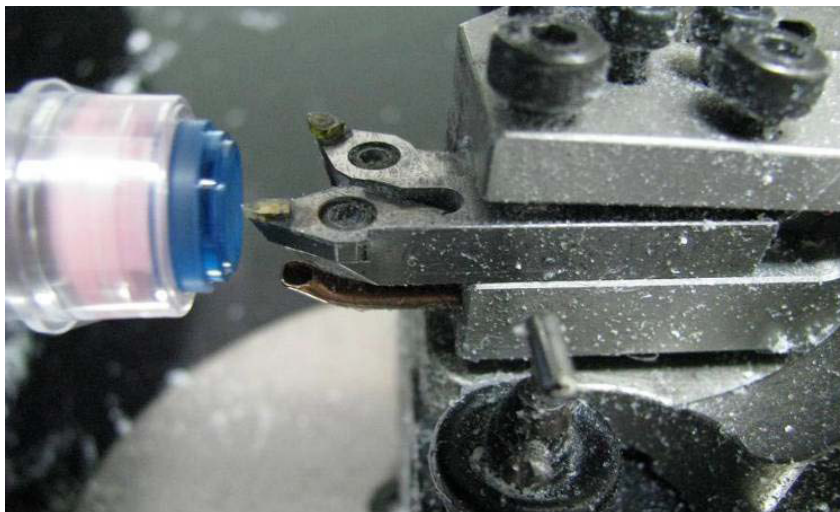
Slika 5.29. Obrada sočiva struganjem ( preuzeto iz [79] )
