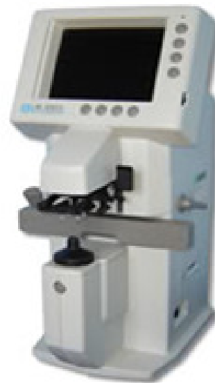
Slika 5.14. Uređaji za merenje optičke snage : Rotlex CONTEST Plus (levo) i digitalni fokometar marke Nidek LM – 990 (desno)
