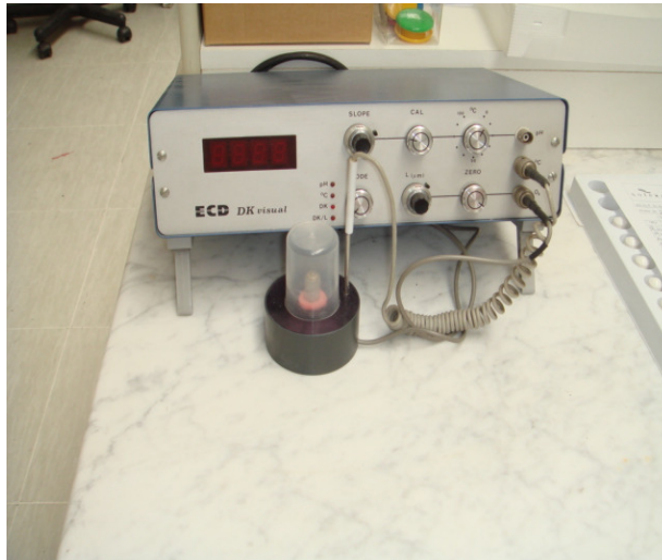
Slika 5.25. Uređaj za merenje Dk
