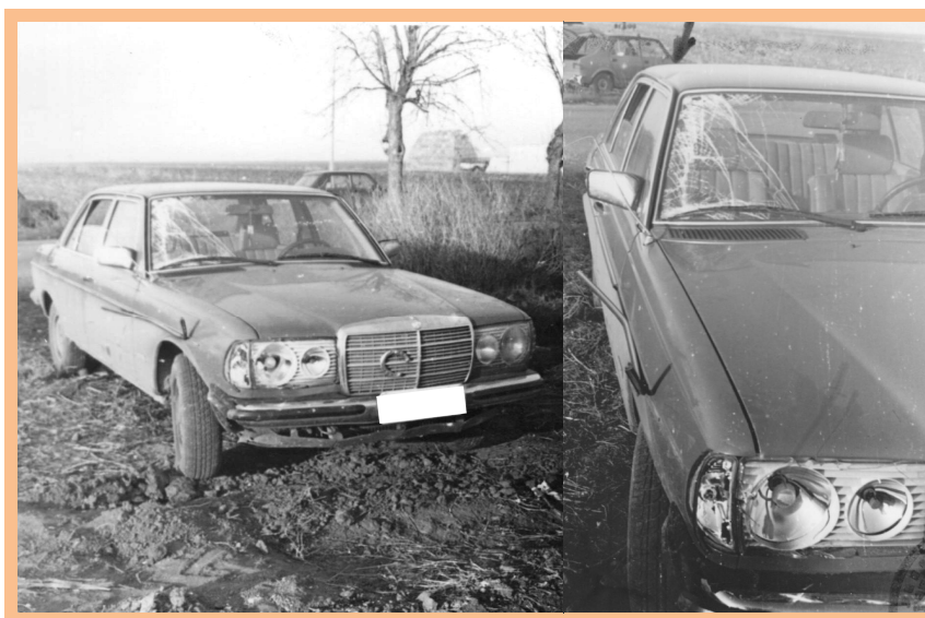
Слика бр. 6.27 – Оштећења предњег дела аутомобила настала током судара са бициклом и бициклистом у сустизању
