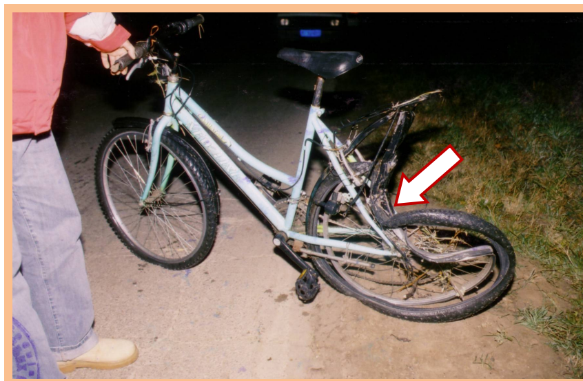
Слика бр. 6.28 – Оштећење задњег точка бицикла настало током судара у сустизању
