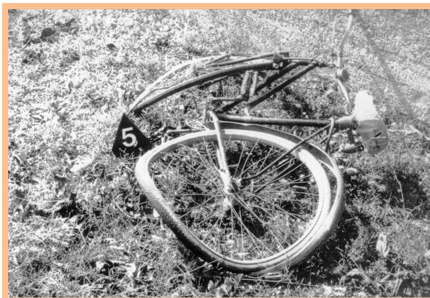
Слика бр. 6.32 – Оштећења бицикла настала током бочног судара бицикла са аутомобилом
