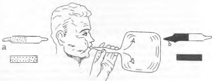
Sl. 2. Alkotest, a) pribor pre upotrebe (žuti reagens), b) pribor posle upotrebe (pozelenjeni reagens).
