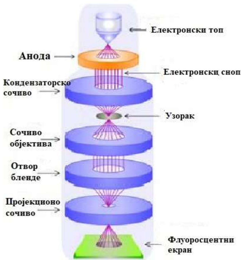
Слика 1.10. Шематски приказ трансмисионог електронског микроскопа. Преузето и модификовано из [27].
