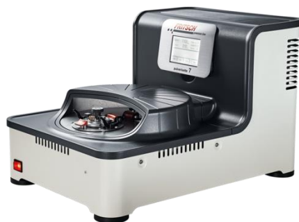
Слика 16. Планетарни куглични млин коришћен за синтезу прашкастих прекурсора: Planetary Micro Mill Pulverisette 7 premium line.
