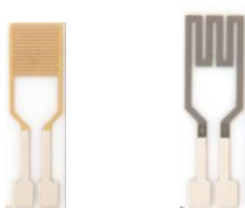
Слика 18. Комерцијални супстрат од алуминијум-оксида; лево: златне интердигиталне електроде; десно: платински грејач.
