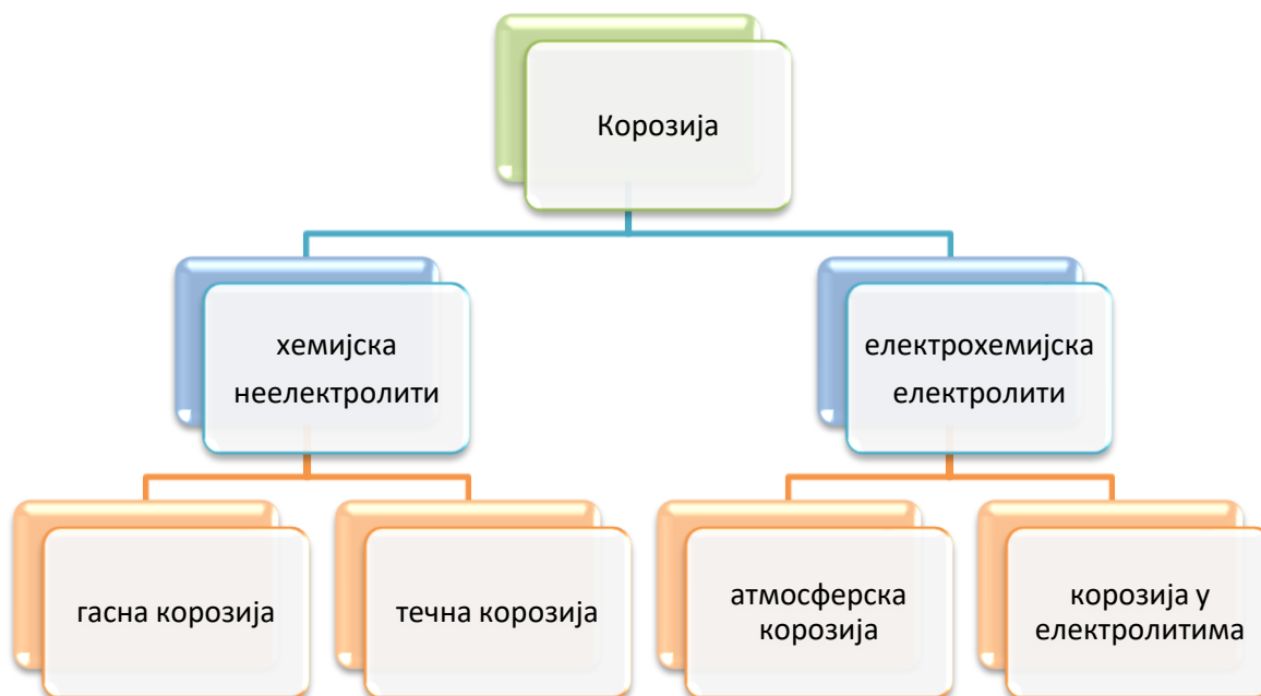
Слика 2.1. Подела корозије према типу корозионог агенса и механизму корозионе реакције
