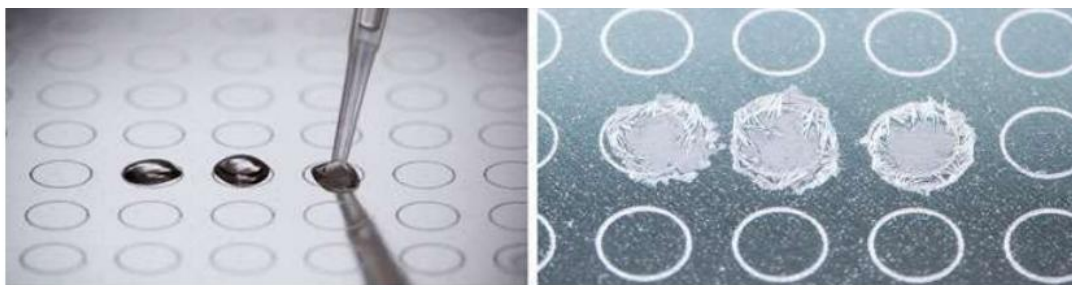
Слика 4.1. Фотографије појединачних спотова/позиција/места увећане камером инсталираном у масеном спектрометру.
