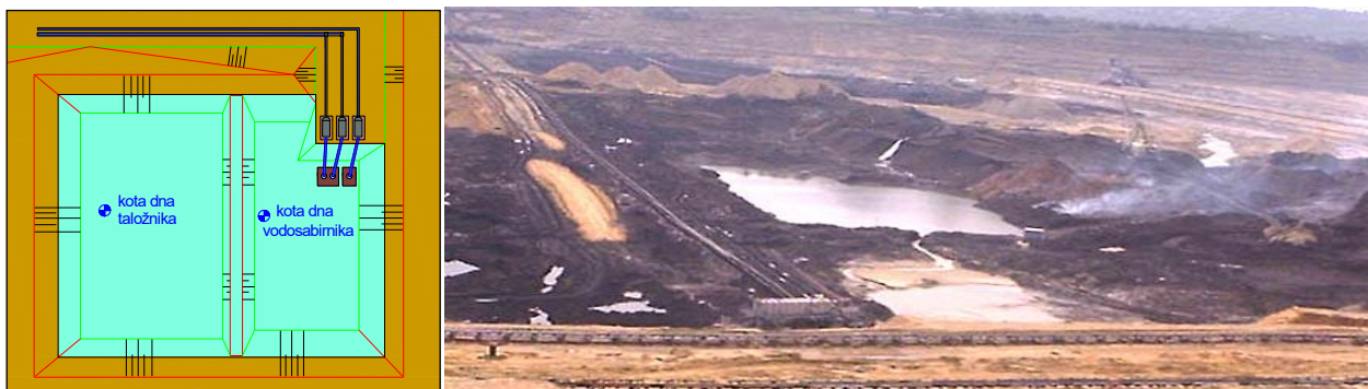
Slika 5.4.4.1. Izgled glavnog vodosabirnika sa taložnikom i pumpnom stanicom na površinskom koku Drmno [139]
