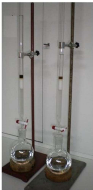
Слика 25. Раздвајање битумена хроматографијом на колони.
