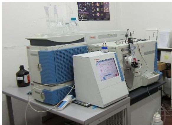
Slika 23. Hibridni maseni spektrometar LTQ Orbitrap XL sa sistemom Acella UHPLC
