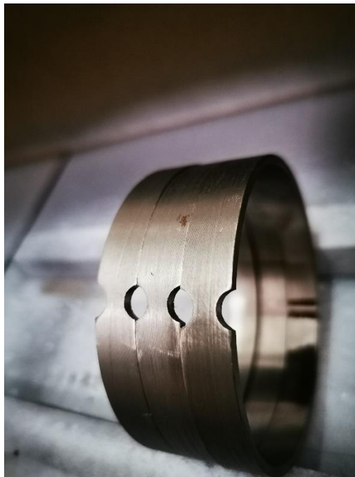
Slika 3.8. RHNT epruvete od materijala P235TR1 .
