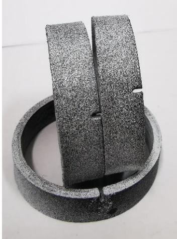
Slika 3.22. Polimerni prstenovi sa nanešenom stohastičkom šarom.
