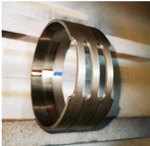
Slika 3.7. RHTT epruvete od materijala P235TR1 .
