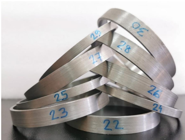
Slika 3.10. PRNT epruvete pripremljene na CNC laseru.
