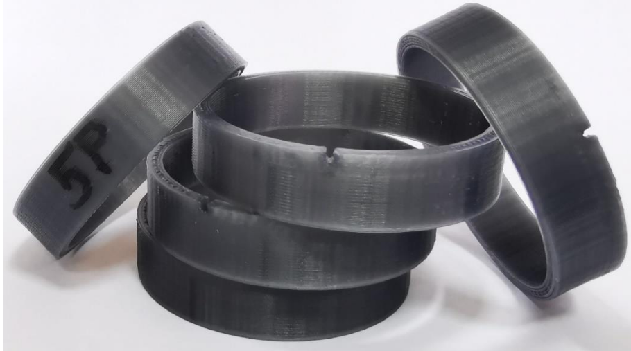
Slika 3.2. PRNT epruvete izrađene FDM tehnikom od PLA materijala.
