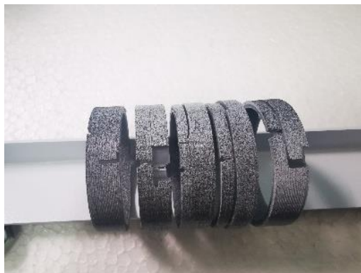
Slika 4.1. Ispitane PRNT epruvete stare 14 dana.
