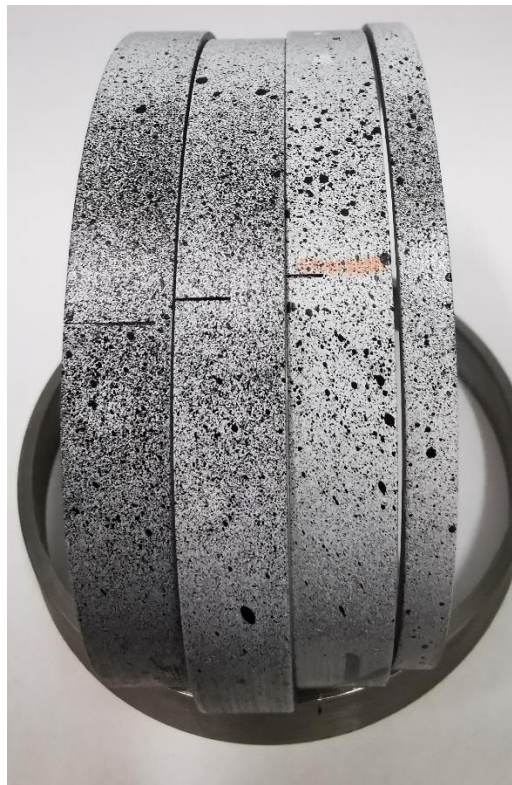
Slika 3.23. Čelične epruvete PRNT sa nanešenom stohastičkom šarom.
