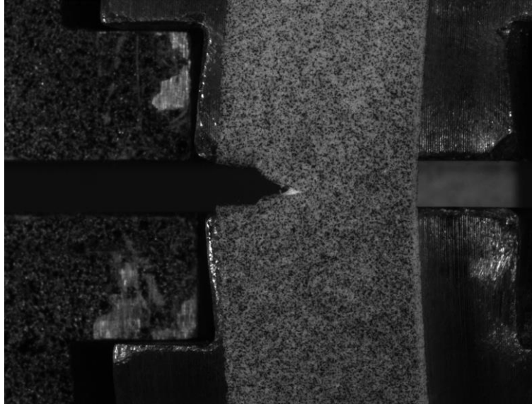
Slika 4.20. Fotografija ispitivanja PRNT epruvete (serija PRNT 4-6) nakon 200s.
