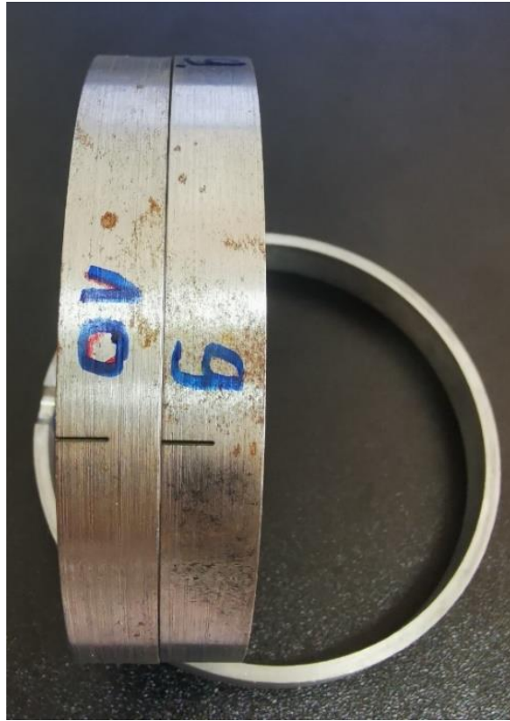
Slika 3.9. PRNT epruvete pripremljene na erozimat.
