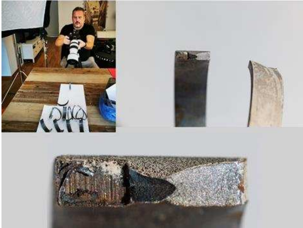
Slika 3.27. Fotografisanje prelomnih površina ispitanih PRNT epruveta.
