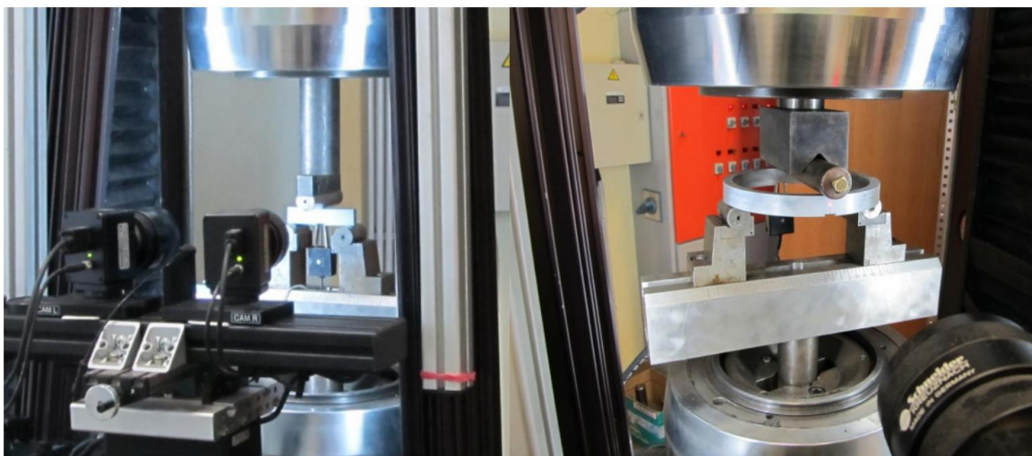
Slika 2.24. Ispitivanje SENB i PRNB epruveta savijanjem u tri tačke uz Aramis sistem [2.60].
