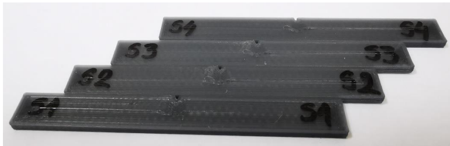
Slika 3.3. SENT epruvete izrađene FDM tehnikom od PLA materijala.
