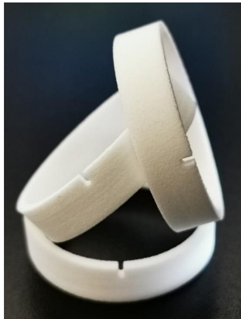
Slika 3.4. PRNT epruvete izrađene SLS tehnikom od materijala PA12 .
