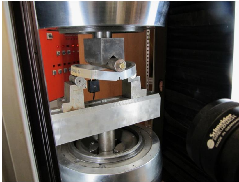
Slika 2.27. Ispitivanje epruvea oblika prstena savijanjem u tri tačke [2.62].
