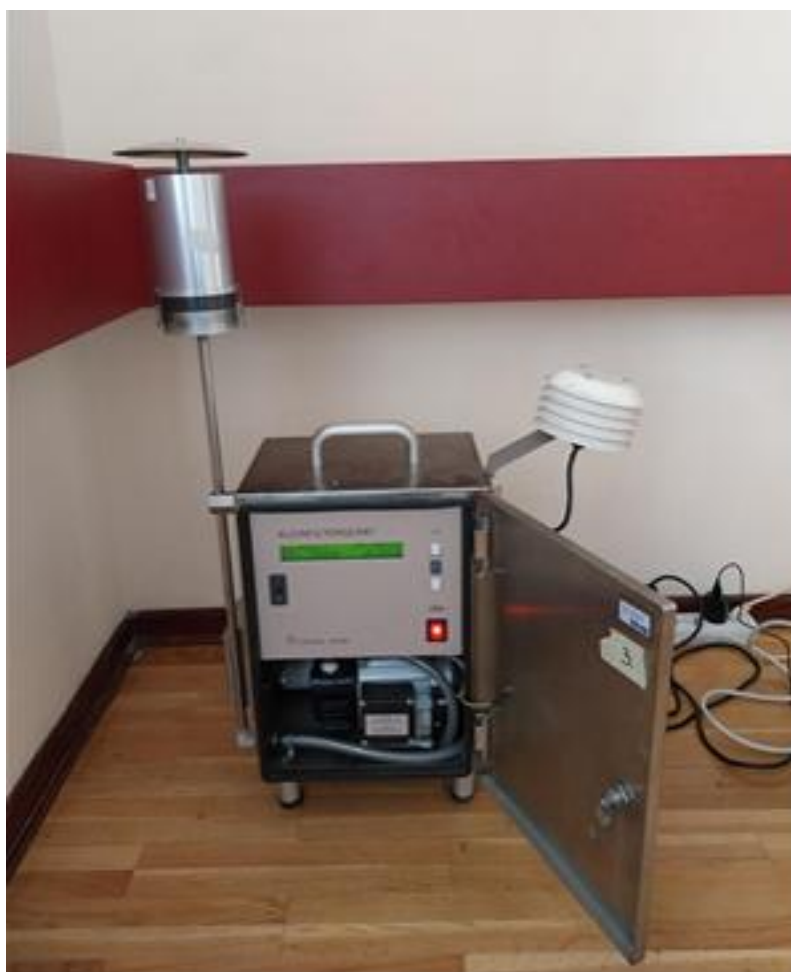
Slika 8. Referentni uzorkivač Sven Leckel LVS6-RV.
