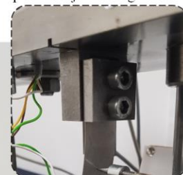
c) Hvataljke (čeljusti) za prihvatanje testnog uzorka
