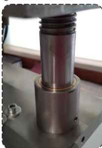
Slika 102: Precizna presa sa lukovima: a) torzioni zglobovi i mjerna čeljust, b) detalj veze honovane vodilice i klizača sa bronzanim ležajem, c) čeljusti za prihvatanje testnog uzorka luka
