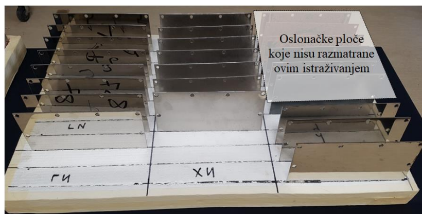
Glatke oslonačke ploče Hrapave oslonačke ploče Oslonačke ploče hrapavosti 2R R_a \approx 13 \text{ nm} R_a \approx 550 \text{ nm} R_a \approx 35 \text{ nm}
