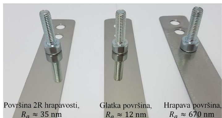
Slika 124: Vizuelni prikaz različite hrapavosti površine za trake od nerđajućeg čelika.
