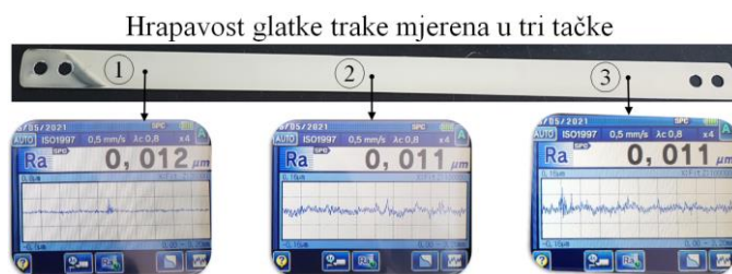
Slika 122: Profil hrapavosti i izmjerena vrijednost R_a za tri mjerene tačke na uzorku glatke trake.
