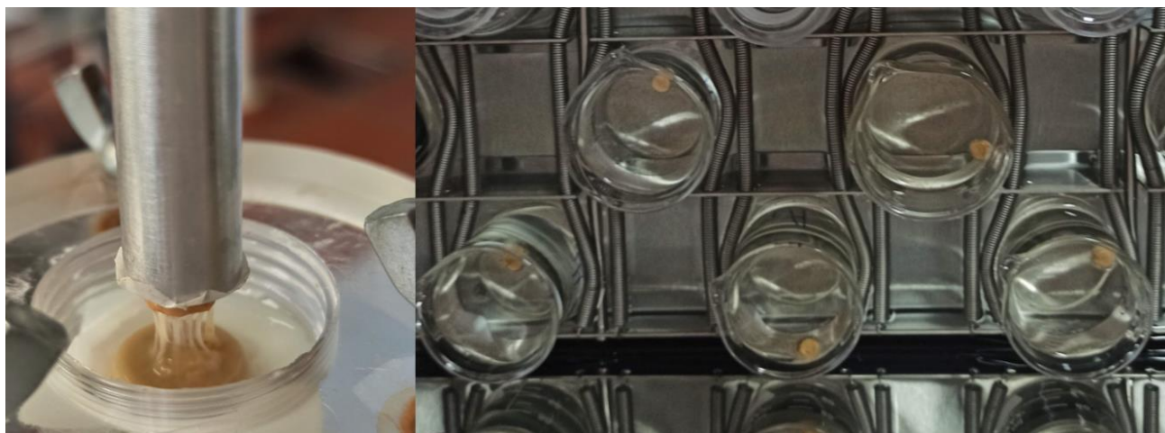
Slika 49. Razvijene tablete sa dualnim mehanizmom gastroretencije poseduju mukoadhezivna svojstva i flotiraju tokom in vitro testa.
