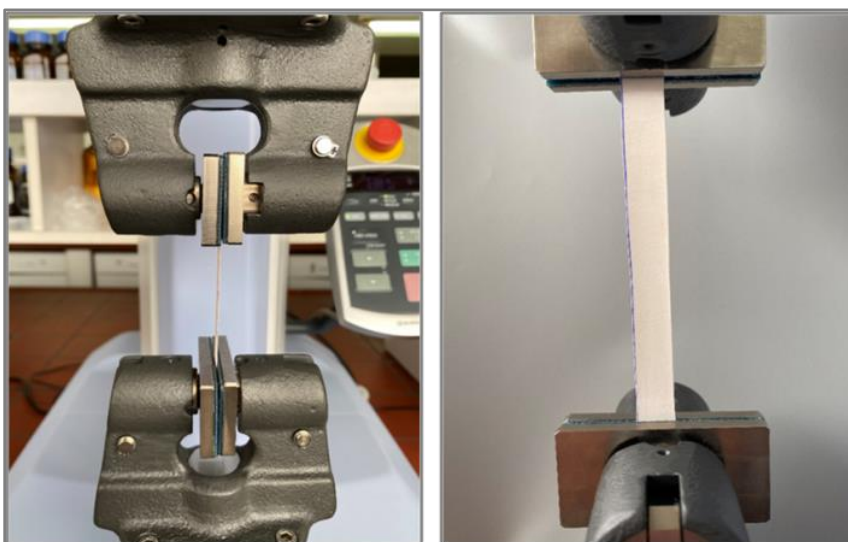
Slika 3.4. Uzorci filma isečeni na pravougaone trake postavljeni između klema (levo) i izgled filma tokom testa istezanja (desno)
