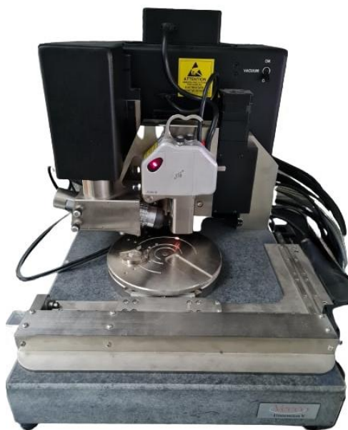
Slika 3.13. Mikroskop atomskih sila (Veeco Bruker DI Dimension Hybrid XYZ Scanning Probe Microscope Head/AFM, Veeco Instruments, Plejnvju, Njujork, SAD).
