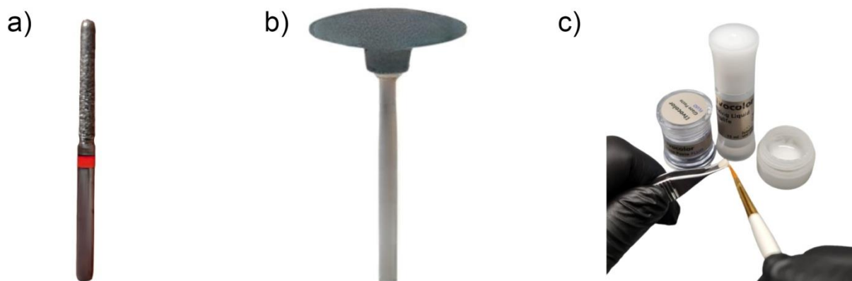
Slika 3.7. Instrumenti i materijali za završnu mehaničku obradu i poliranje uzoraka od cirkonije: (a) Dijamantsko svrdlo (Diamond Cylinder 881F Fine/5, Meisinger, Ivoclar Vivadent, Šan, Lihtenštajn). (b) Gumica za poliranje (Jota Zirconflex Grinder, Jota, Ruti, Švajcarska). (c) Nanošenje sloja glazure po površini uzorka cirkonije.
