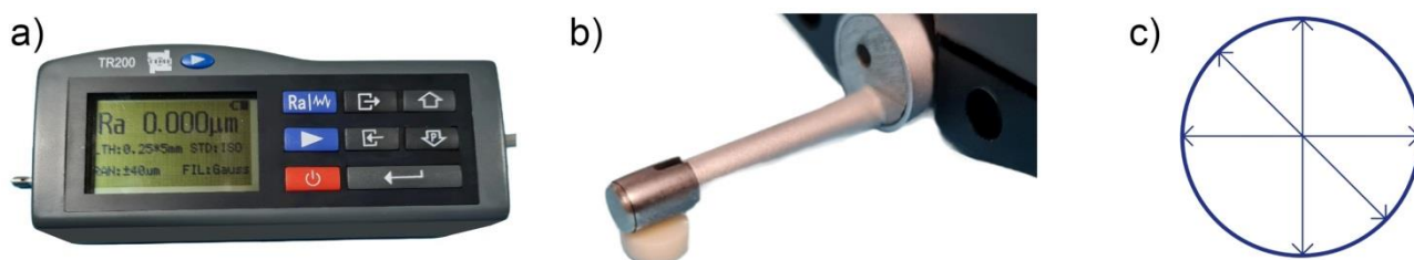
Slika 3.11. Merenje površinske hrapavosti uzoraka materijala: (a) Kontaktni profilometar (Surface Roughness Tester TR200, Beijing TIME High Technology, Peking, Kina). (b) Princip merenja površinske hrapavosti postavljanjem specijalne sonde sa dijamantskim vrhom na deo površine uzorka materijala. (c) Pravci merenja površinske hrapavosti uzoraka.
