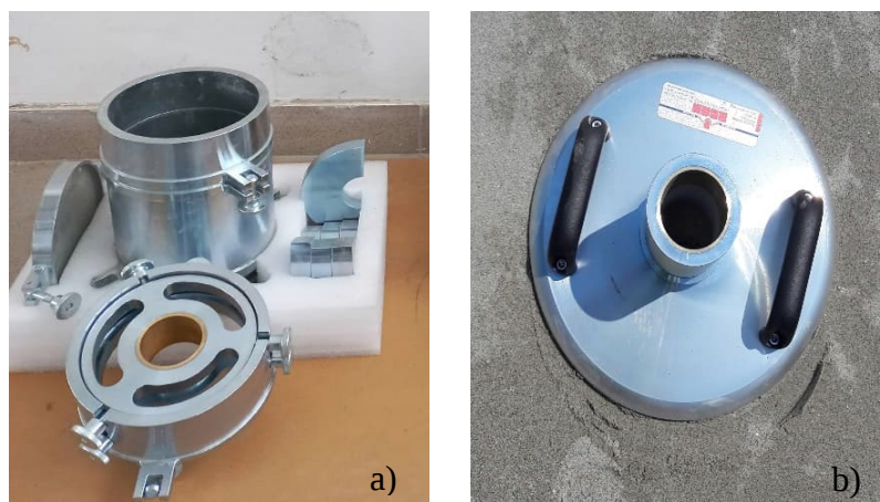
Slika 3.17. a) CBR d kalup (Ø 150 mm) i prateće komponente b) Kružna ploča sa vođicom za CBR d klip (Ø 300 mm)
