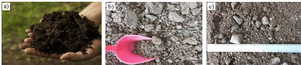
Slika 2.2. Osnovne vrste prirodnih „zemljanih“ materijala a) Humusni materijal b) Sitnozrni vezani materijal, c) krupnozrni nevezani materijal
