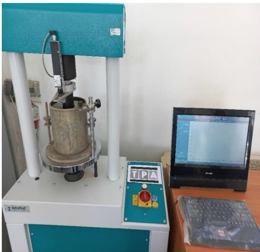
Slika 3.8. Statičko (klasično) CBR ispitivanje
