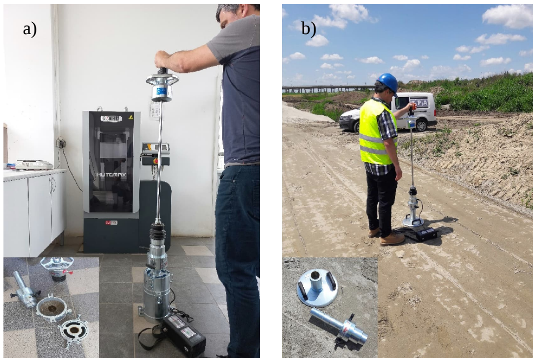
Slika 3.18. Dinamičko CBR d ispitivanje, korišćenje uređaja sa padajućim tegom LWD za izazivanje definisanog udarnog opterećenja na CBR d klip a) CBR d – Laboratorijsko ispitivanje b) CBR d – „In situ“ ispitivanje
