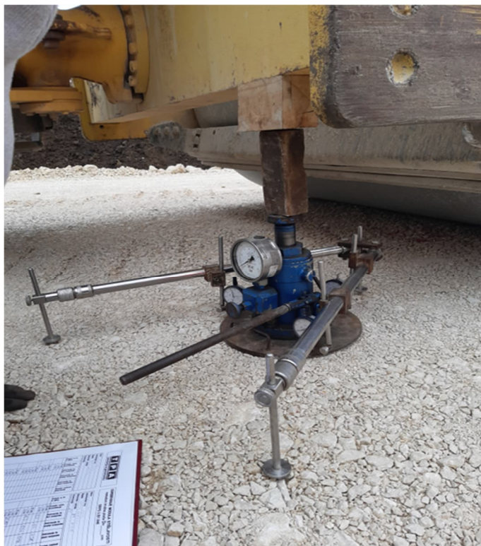
Slika 3.13. Merenje modula stišljivosti - M_s , sloj posteljice na lokaciji izgrađenog državnog puta Ib reda broj 22
