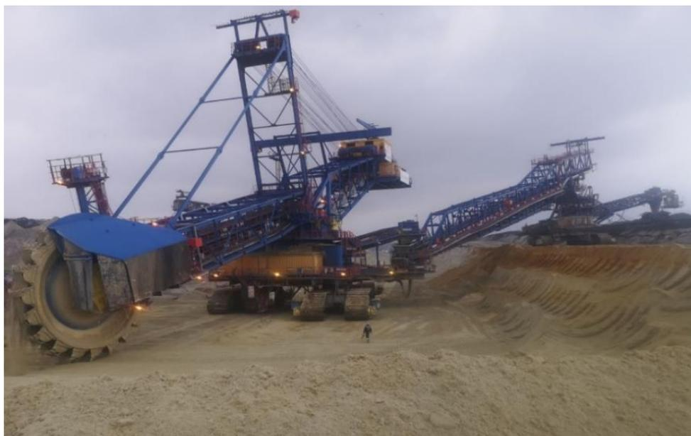
Слика 4.10. Роторни багер SchRs 1400 28/3 на површинском копу Поље Б Колубара (приватна архива)
