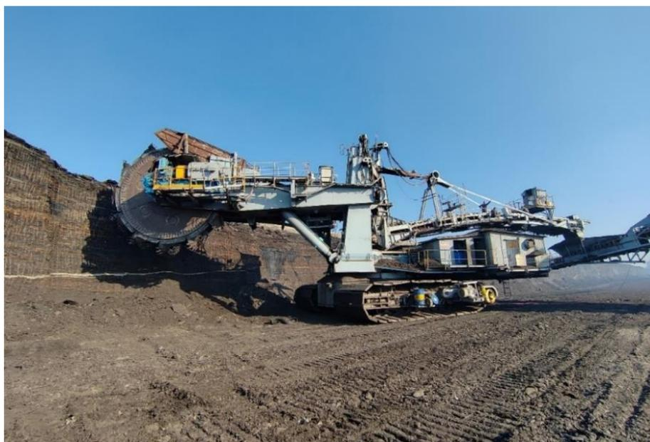
Слика 4.5. Роторни багер SRs 400.14/1 (приватна архива)
