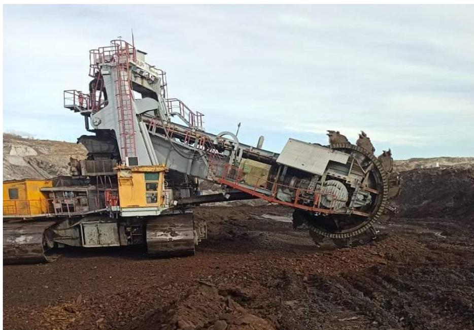
Слика 4.6. Роторни багер C 700 S на површинском копу поље Б Колубара (приватна архива)
