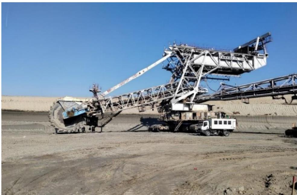
Слика 4.8. Роторни багер SRs 1300 на површинском копу Дрмно (приватна архива)
