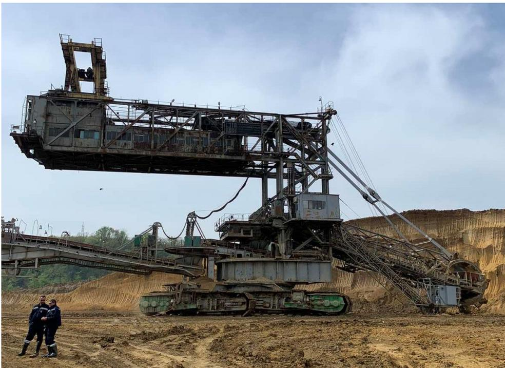
Слика 4.7. Роторни багер SRs 1200 на површинском копу Поље Б Колубара (приватна архива)
