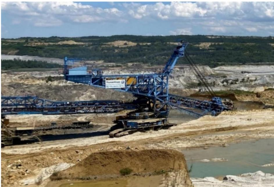
Слика 4.9. Роторни багер SchRs 1760 на површинском копу Поље Д Колубара (приватна архива)
