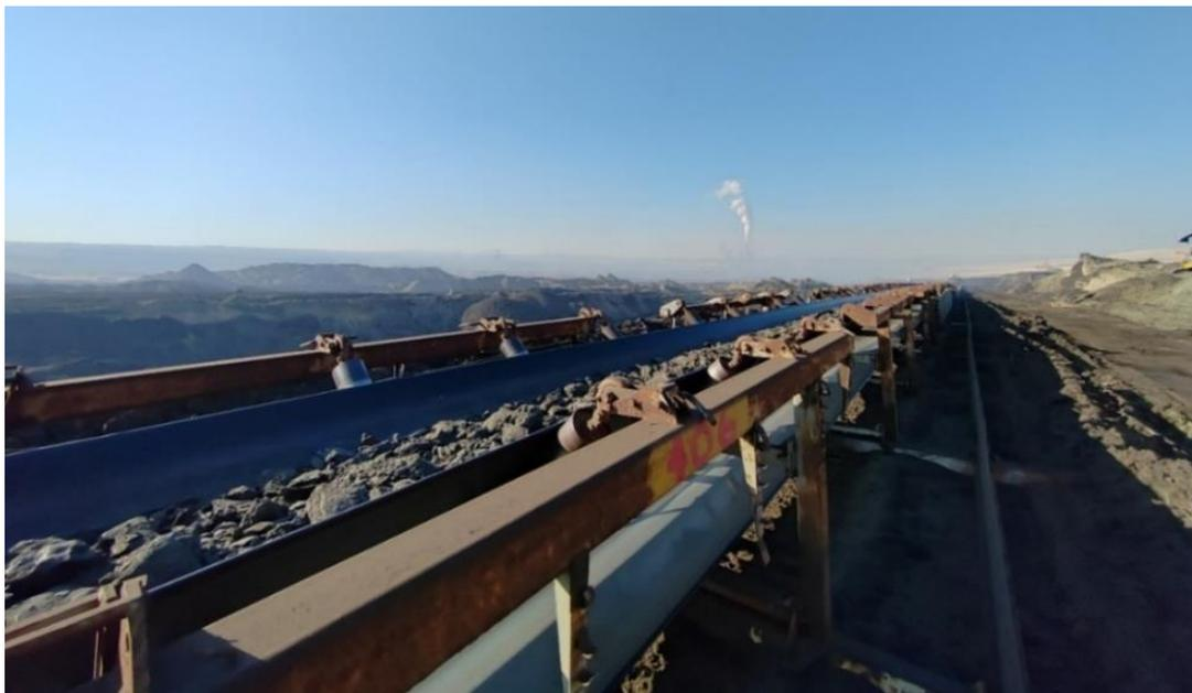
Слика 4.16. Транспортер са траком на угљу површински коп Дрмно (приватна архива)
