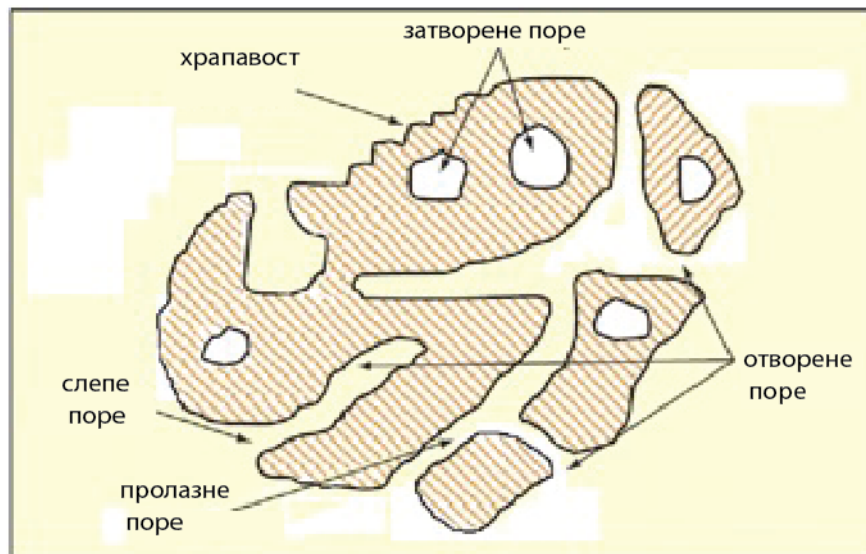
Слика 2.2 Графички приказ пресека порозног чврстог материјала(преузето из Arenas and Crocker 2010).
