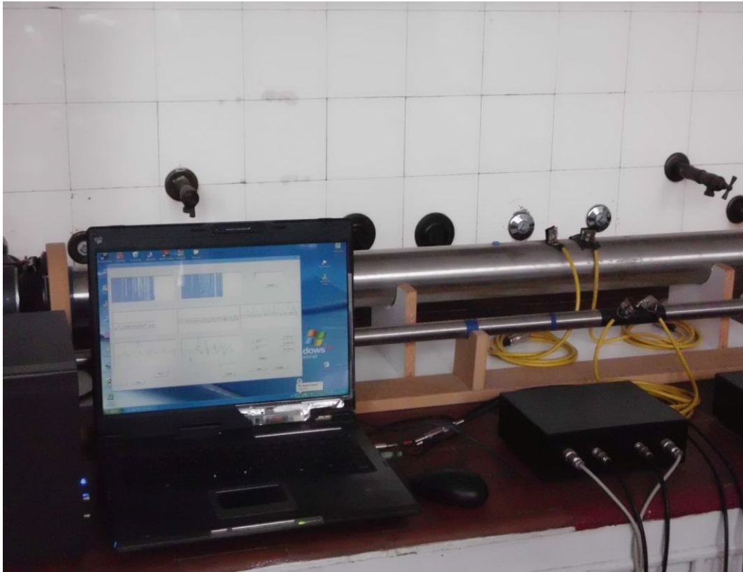
Слика 5.2 Апаратура за мерење коефицијента апсорпције звука(SAC) материјала са звучном цеви и два микрофона према (ISO 10534-2)
