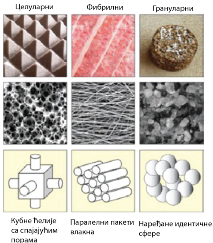
Слика 2.3 Три основна типа порозних апсорбујућих материјала (преузето из Arenas and Crocker 2010).
