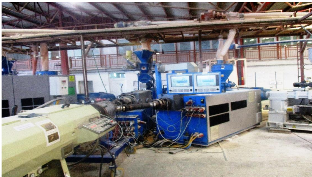
Slika 15. Tandem dvopužnih ekstrudera (Theysohn)
