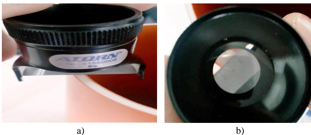
Slika 28. Određivanje debljine slojeva od UPVC-a a) lupa sa milimetarskom podelom i b) merenje debljine slojeva
