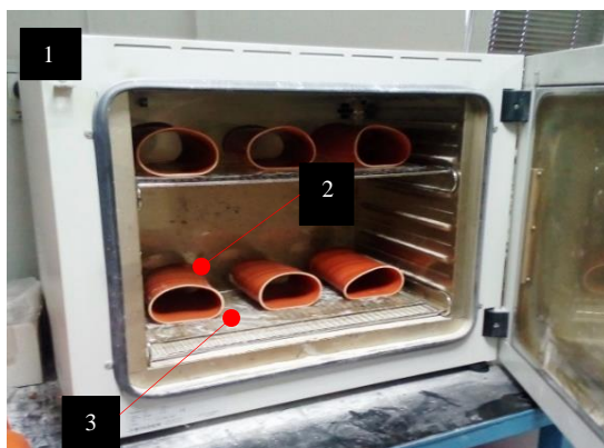
Slika 26. Postupak ispitivanja uzdužnog skupljanja cevi: Slika 27. IR termometar HT6889 (1) peć-sušara, (2) uzorak i (3) talk
