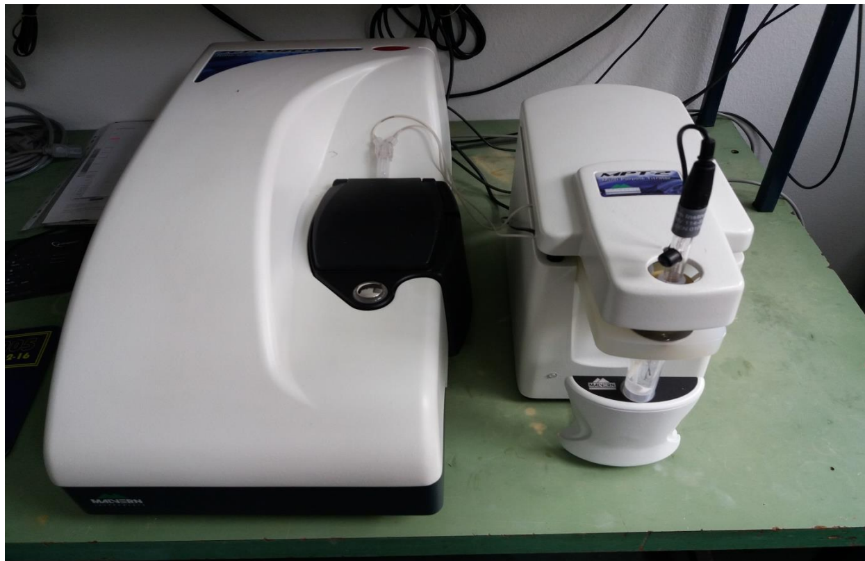
Slika 25. Zeta-sizer za određivanje veličine čestica i zeta potencijala
