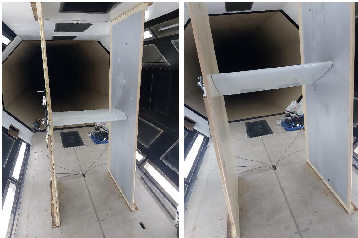
Слика 6.3.1 Аеропрофил NASA 2415 постављен у испитну инсталацију у аеротунелу, пре монтирања дефлектора, који се уклањају при уградњи модела
