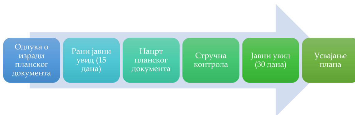
Слика 9. Поступак доношења просторних планова (Аутор на основу Закона о планирању и изградњи, 2021)
