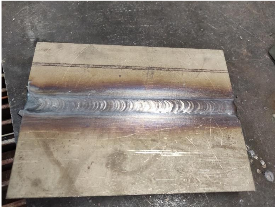
Slika 4.3: Izgled jedne od zavarenih ploča dupleks čelika S32750
