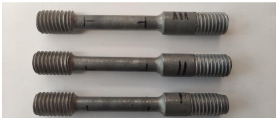
Slika 5.4: Izgled epruveta zavarenog spoja za ispitivanje zatezanjem
