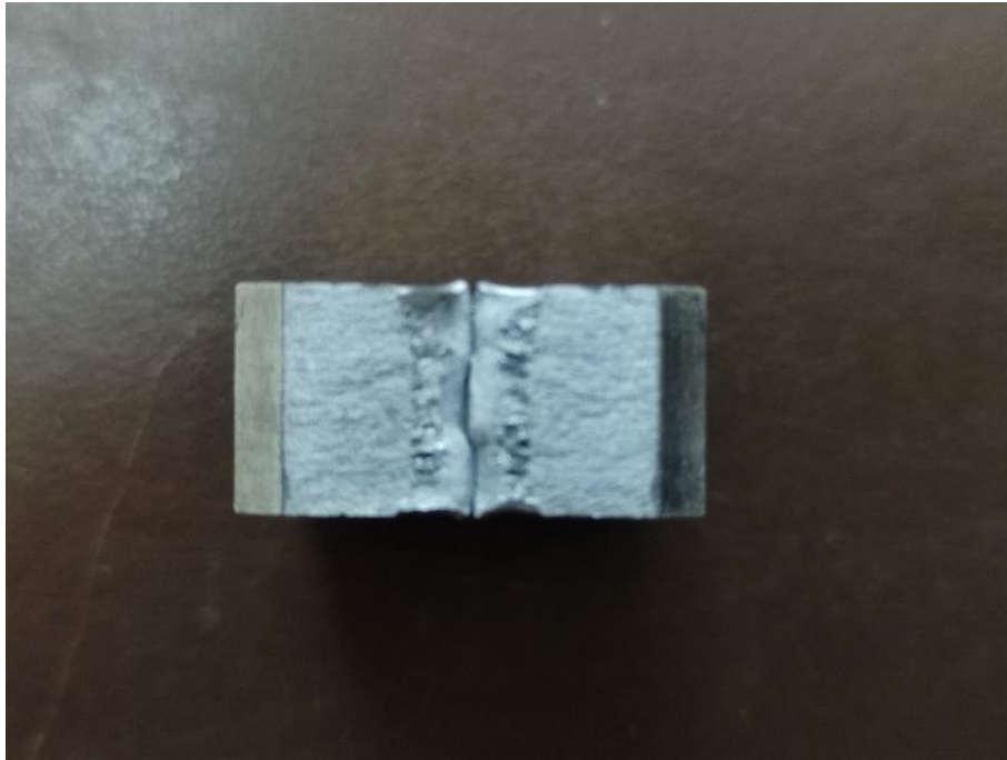
Slika 5.14: Reprezentativni presek epruvete na mestu preloma
