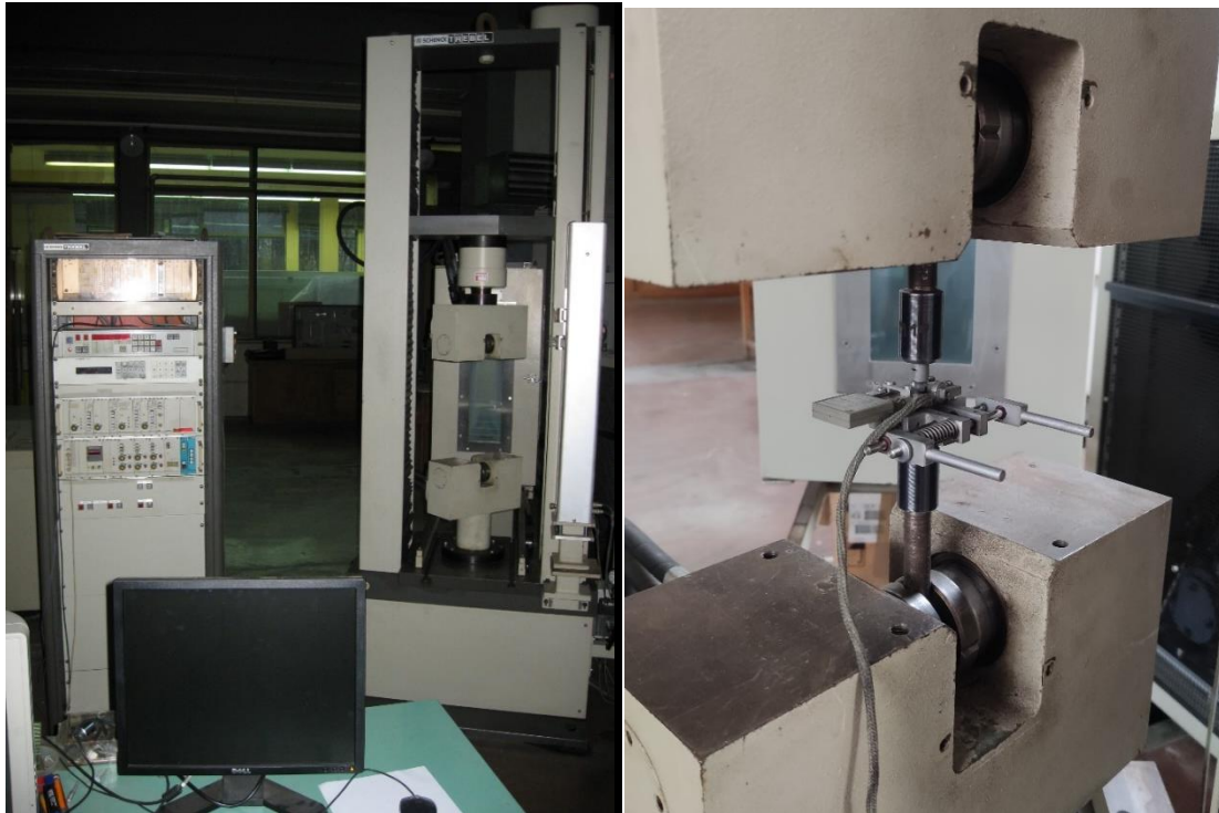
Slika 5.2: Izgled ispitnog uređaja i postavke ispitivanja zatezanjem
