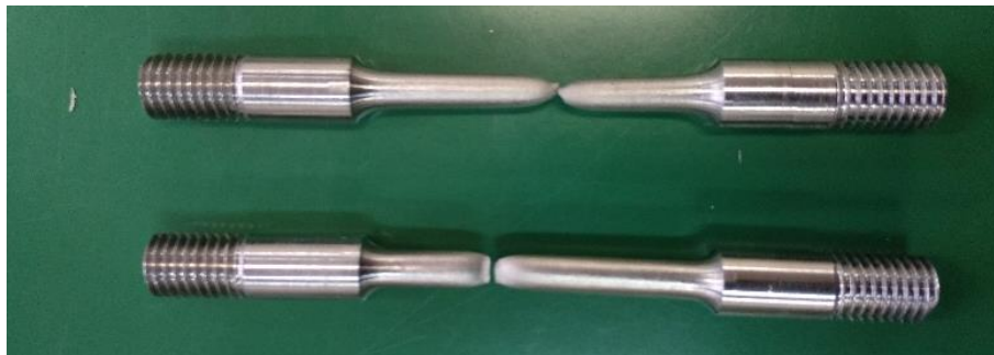
Slika 5.3: Izgled epruveta OM za ispitivanje zatezanjem
