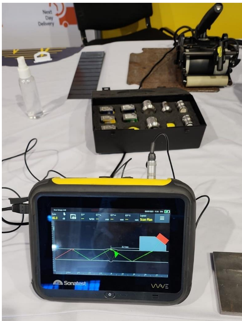
Slika 8. Savremeni ultrazvučni aparat; model: Wave; proizvođač: Sonatest Ltd, Engleska
