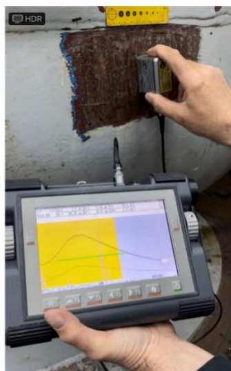
Fotografija broj 13-Indikacija 1.3-Rezultat ispitivanja-Zona maksimalnog ehoa
