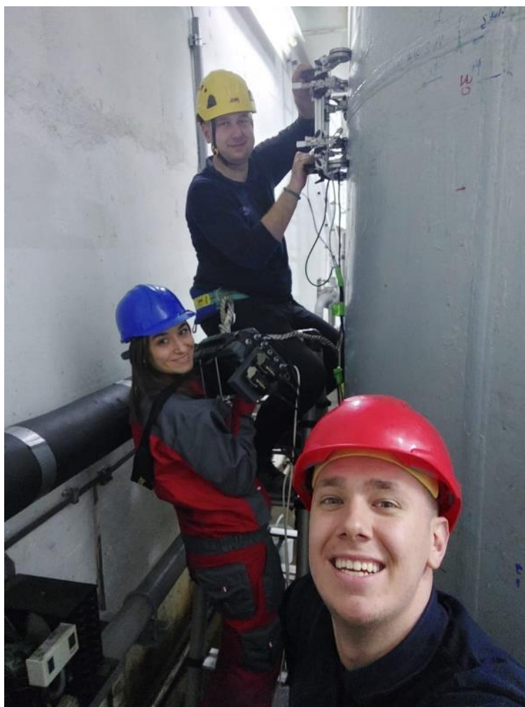
Slika 26(a). Ispitvanje SP 970 naprednim metoda PAUT i ToFD; Ispitivači: Filip Pavlović, Miloš Pantelić (IMW Institut – Kragujevac), Mirjana – F. Opačić (Inovacioni Centar Mašinski Fakultet UB); uređaj: Sonatest Veo +
