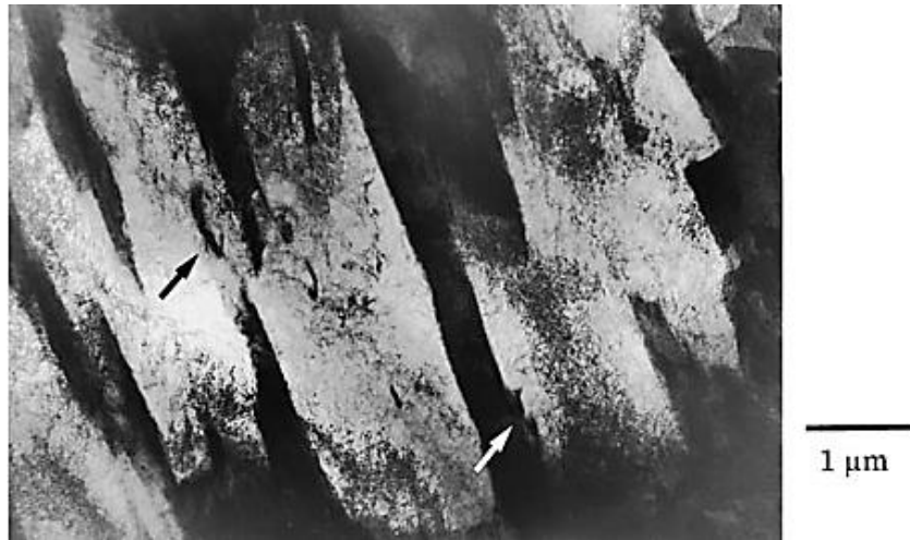
Слика 52. Микроструктура дегенерисаног Видманштетеновог ферита (бела стрелица означава границу са степенастом морфологијом а црна стрелица област нетрансформисане основе која је заробљена између феритних плочица/штапића) [110].
