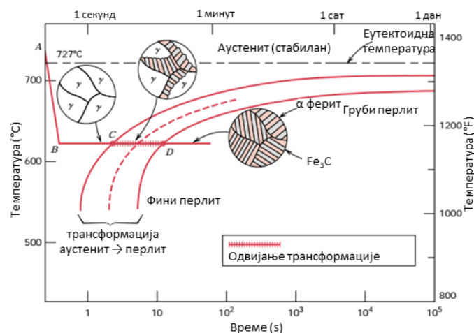
Слика 8. ИР дијаграм еутектоидног челика са примером развоја микроструктуре при изотермалном разлагању аустенита на \sim 600^{\circ}\text{C} [52].
