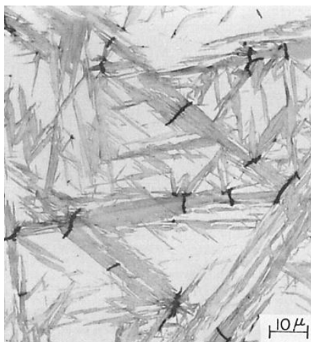
Слика 60. Микроструктура плочастог мартензита са микропрелинама [126].
