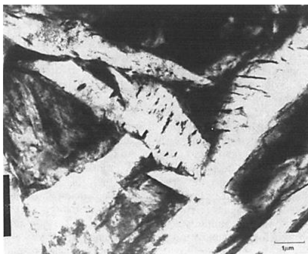
Слика 51. Доњи ацикуларни ферит, плочице цементита издвојене унутар феритне плочице [98].
