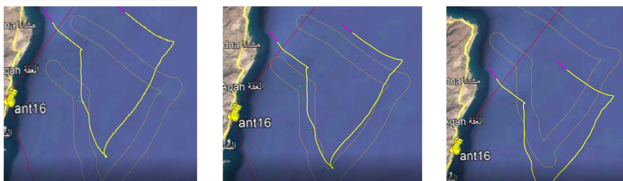
Слика 6.29: Приказ тестова валидности добијених детекција за произвољно померене критеријумске контуре око трајекторије чамца [104]
