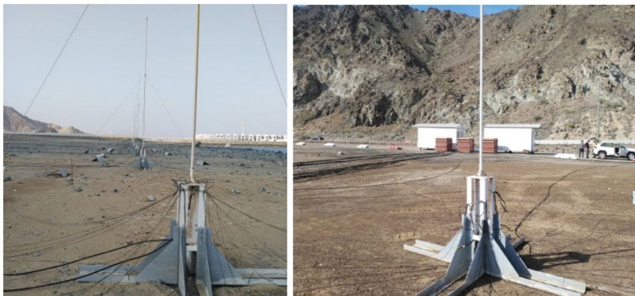
Слика 6.2: Практична реализација архитектура 2 и 3: Изглед првог линеарног пријемног антенског низа у планарном низу (лево) и изглед једне од антена у предајном антенском низу (десно)
