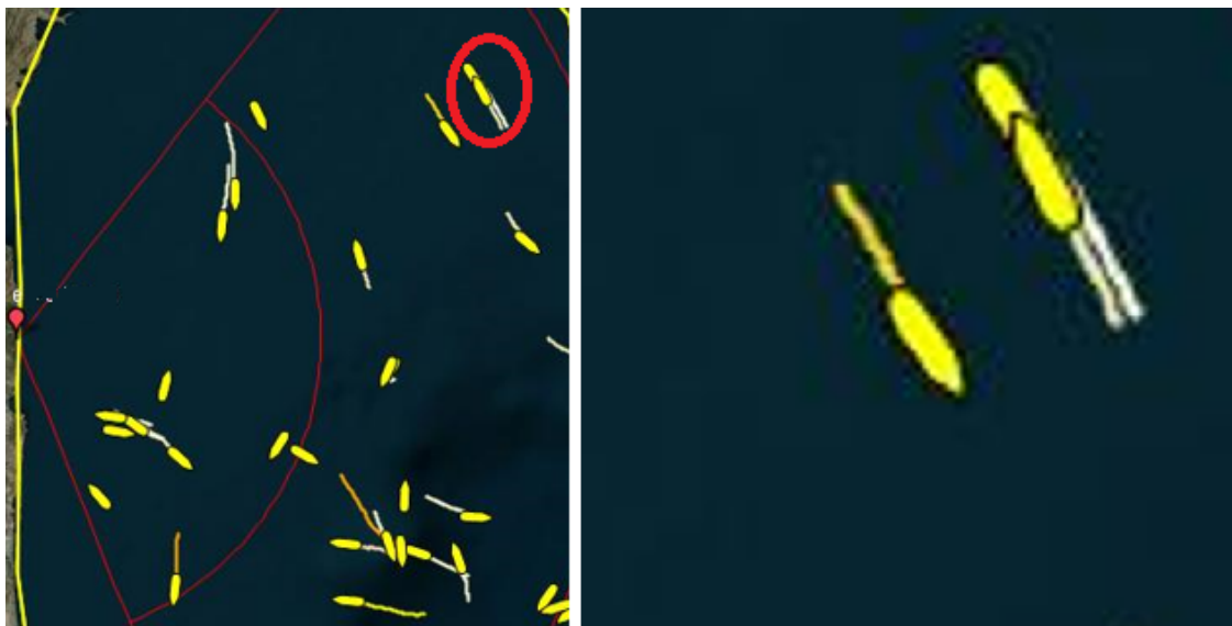
Слика 5.10: Раздвојивост циљева, који су на малом међусобном растојању, помоћу високорезолуционе примарне обраде сигнала
