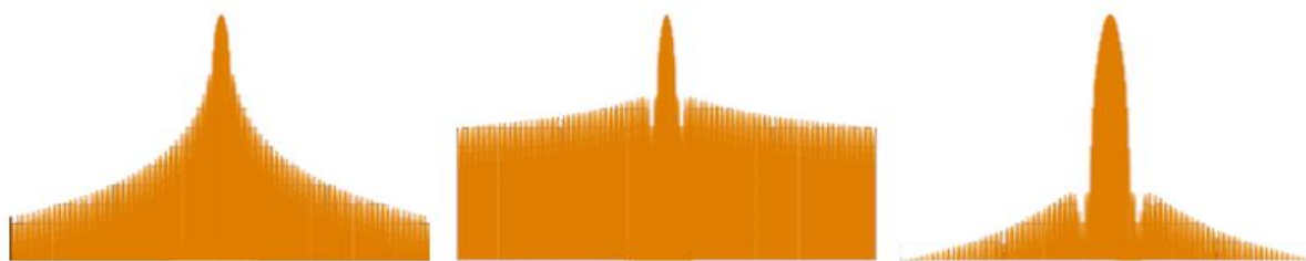
Slika 3.9 Izgled amplitudnih spektara dobijenih nakon modifikacije sirovog signala određene frekvencije Hanovom (levi grafikon), Hemingovom (srednji grafikon) i Blekman-Harisovom (desni grafikon) prozorskom funkcijom.
