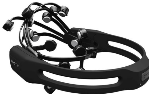
Slika 7.12 Model EEG uređaja korišćen u istraživanju – Emotiv EPOC+.
