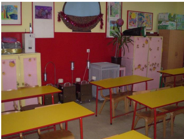
Slika 5. Uzorkovanje u unutrašnjem prostoru pomoću Leckel pumpi (levo) i OSIRIS uređaja (desno).
