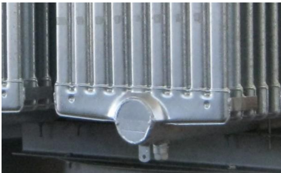
Сл. 7.1 – Глава радијатора, сликано у испитној станици Фабрике трансформатора „Тамини Трансформатори С.р.л.“
