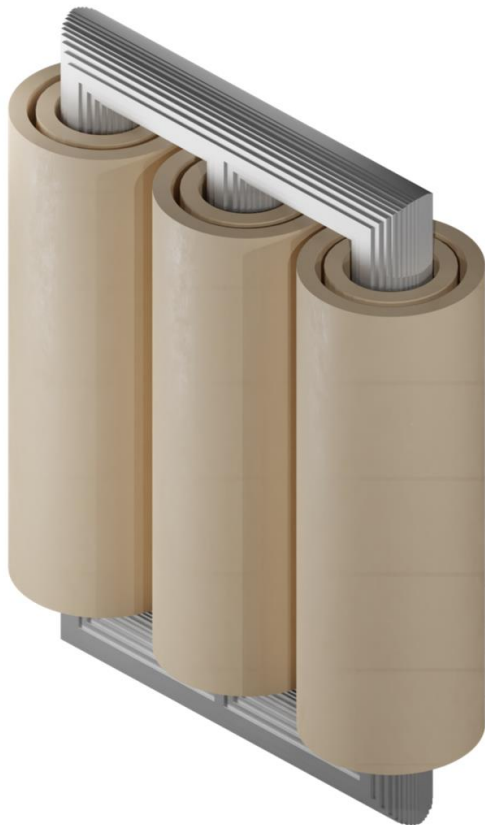
Сл. 2.5 – Илустрација трансформатора са магнетским колом типа „језгро“ (слика лево) и типа „оклоп“ (слика десно)
