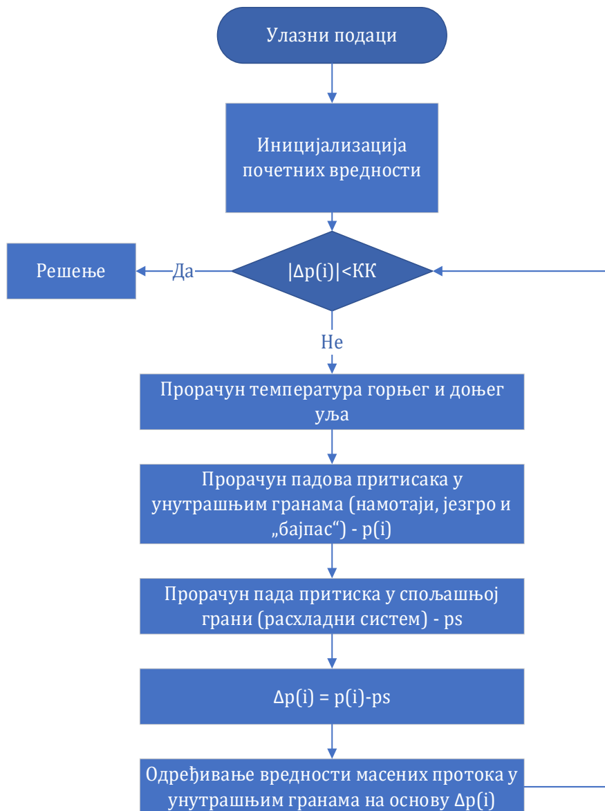
Сл. 4.10 – Рачунарски алгоритам за одређивање масеног протока уља кроз гране глобалне шеме (са K K означен је критеријум конвергенције)
