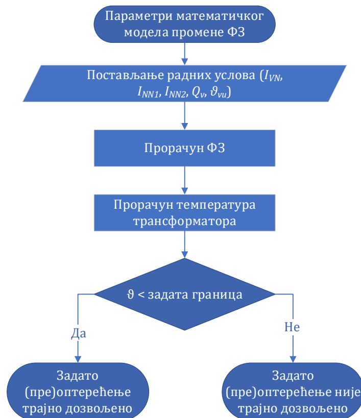
Сл. 9.20 – Алгоритам рачунарског програма за одређивање могућности тренутног (пре)оптерећења
