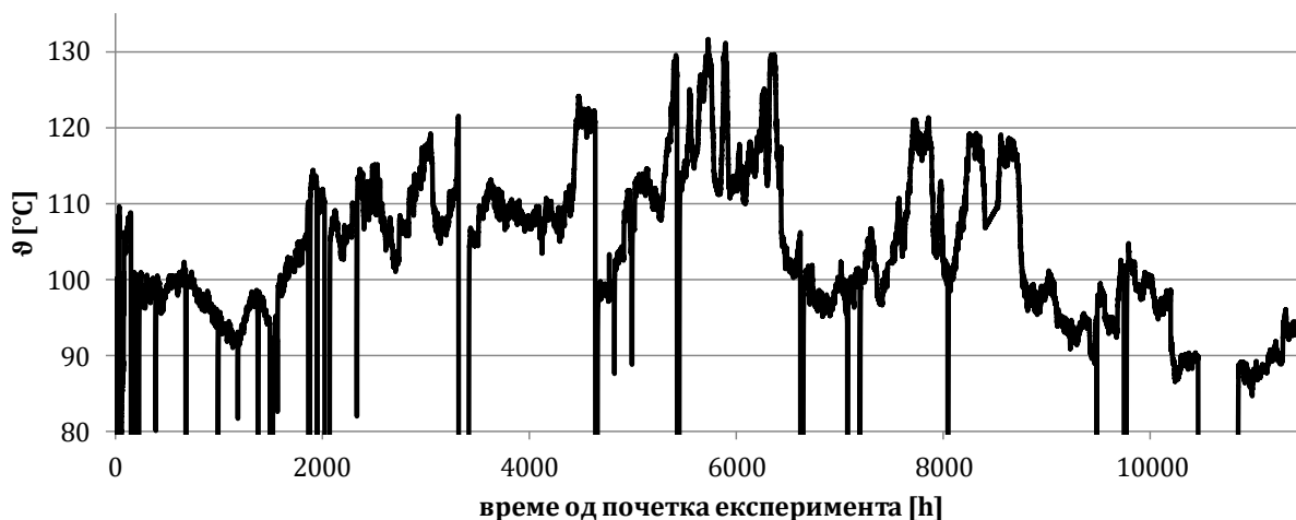
Сл. 5.8 – Температура мерена FO сензором на месту највише очекиване температуре ВН намотаја, средње фазе трансформатора са 4% почетног садржаја влаге у папиру
