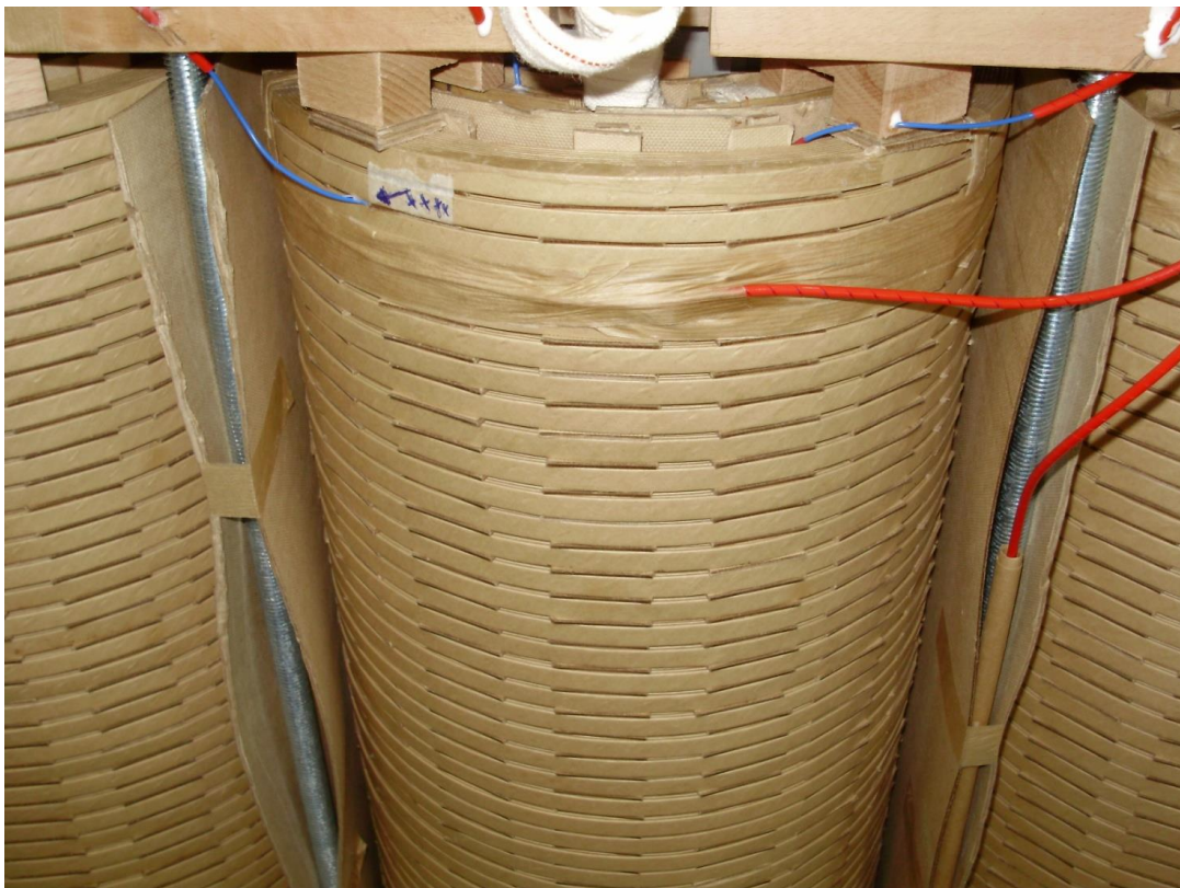
Сл. 5.5 – Експериментални енергетски уљни трансформатори у Фабрици трансформатора „Минел Динамо“ (а) експериментални трансформатори на уласку у сушач, б) постављање фибер-оптичких сензора за мерење температуре)
