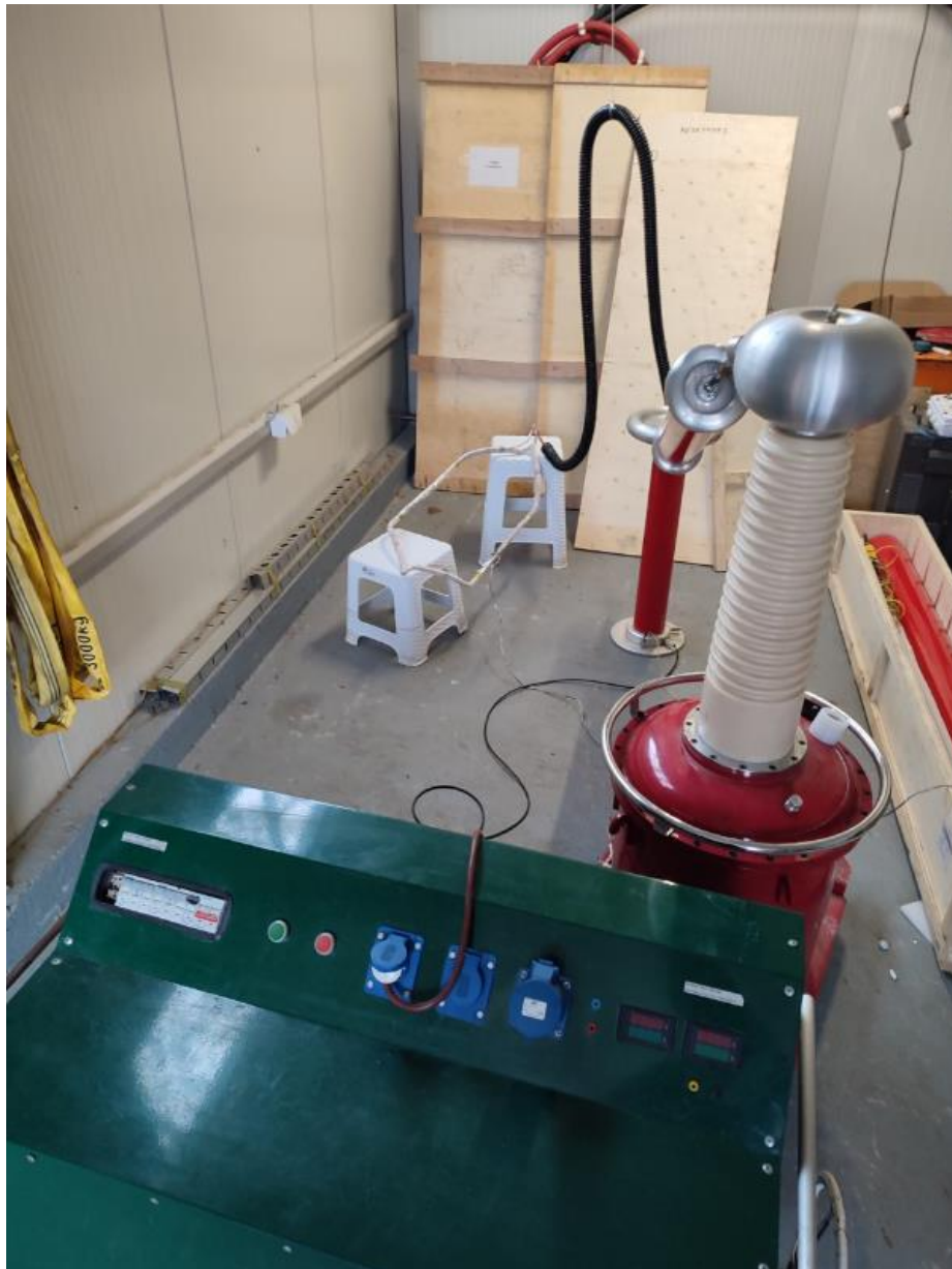
Sl. 9.2 Ispitivanje PDIV i VBD na uzorcima VN mašine
