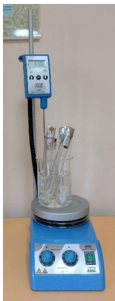
Слика 4.21: Експериментална поставка за in vitro контролисано отпуштање лека.
