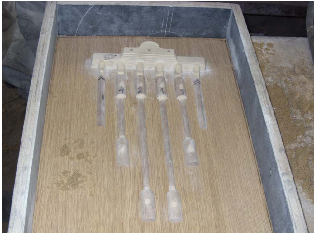
Slika 33 Koš-kutija za izradu donje polovine kalupa
