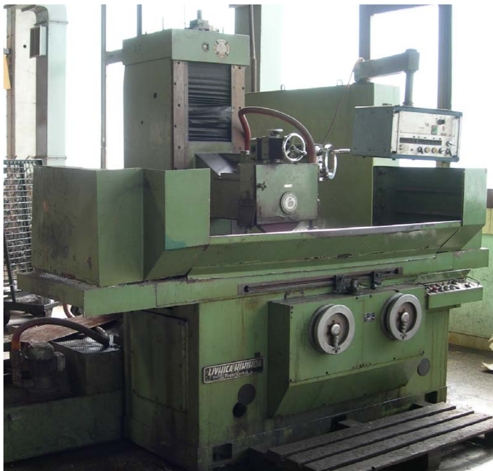
Slika 46 Brusilica LŽT – Kikinda, tip: PRB 500/800
