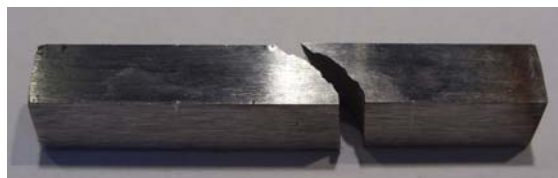
Slika 58 Izgled prelomljenog probnog uzorka
