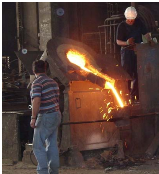
Slika 35 Izgled indukcijske peći ABB tipa ITMK-500
