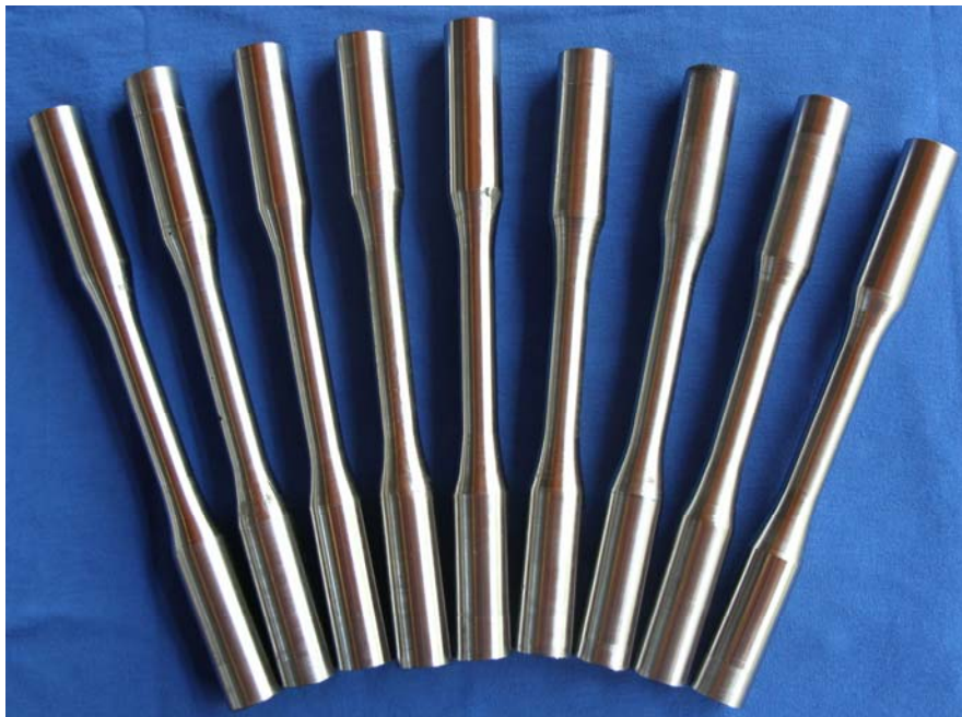
Slika 50 Izgled epruveta za ispitivanje zatezanjem posle mehaničke obrade
