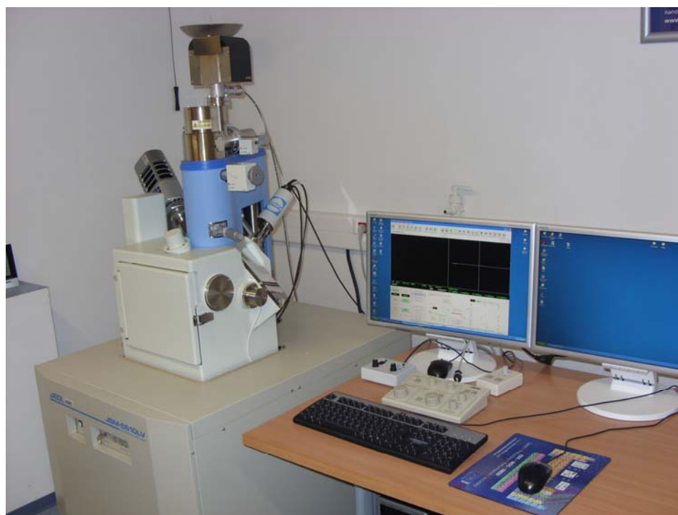
Slika 67 Izgled SEM uređaja JEOL tip JSM-6610LV
