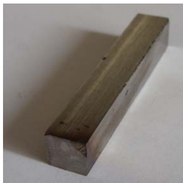
Slika 57 Izgled probnog uzorka za ispitivanje udarne žilavosti po Šarpi metodi
