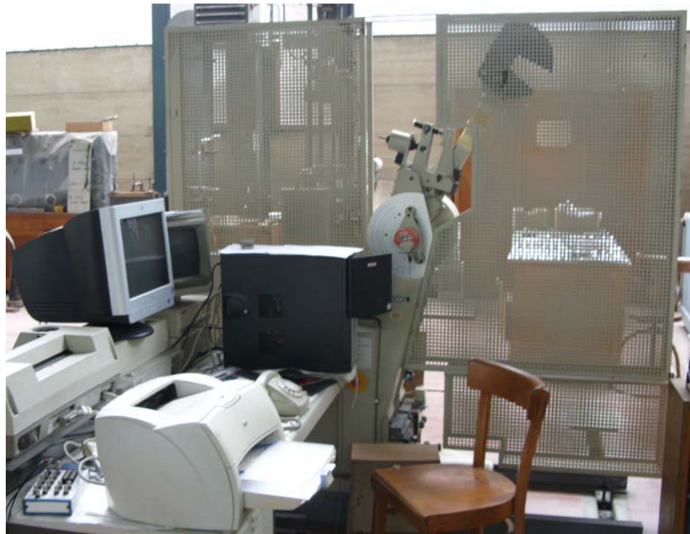
Slika 56 Instrumentirano Šarpijevo klatno „SCHENCK-TREBEL“ 150/300 J
