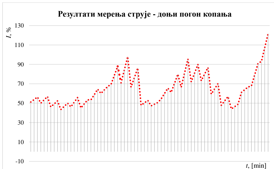
Слика 8.7. Струја коју доњи погон копања повлачи из мреже – похабаност 25 %
