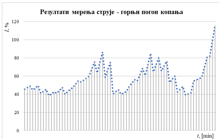
Слика 8.6. Струја коју горњи погон копања повлачи из мреже – нови резни елементи
