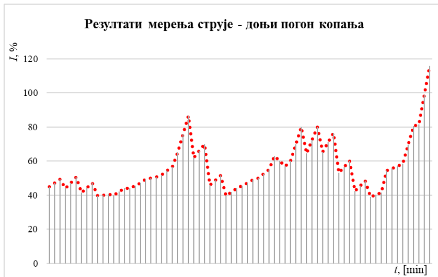
Слика 8.5. Струја коју доњи погон копања повлачи из мреже – нови резни елементи
