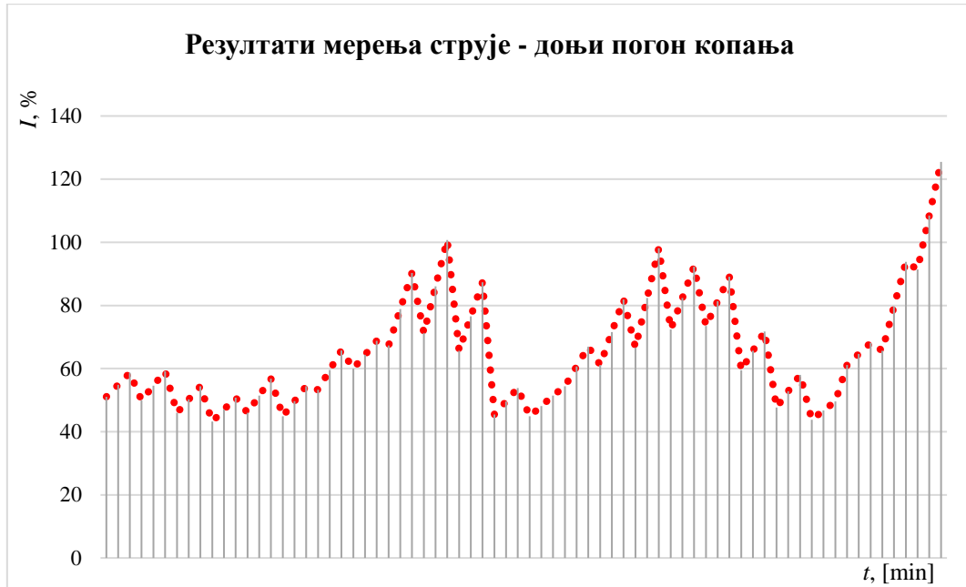
Слика 8.9. Струја коју доњи погон копања повлачи из мреже – похабаност 50 %
