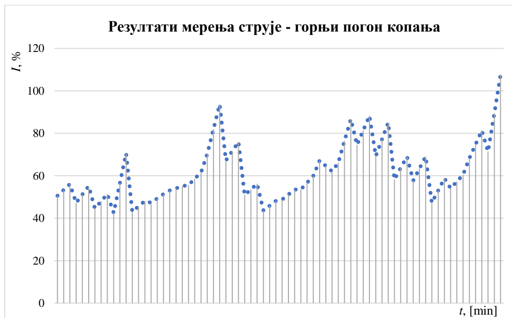
Слика 8.8. Струја коју горњи погон копања повлачи из мреже – похабаност 25 %
