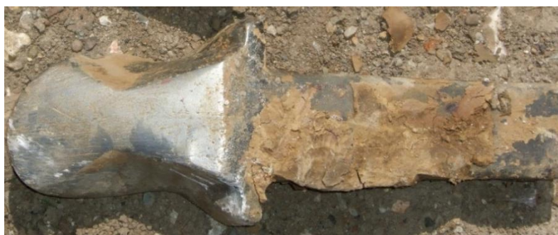
Слика 3.8. Зуб роторног багера SRs2000.32/5+VR
