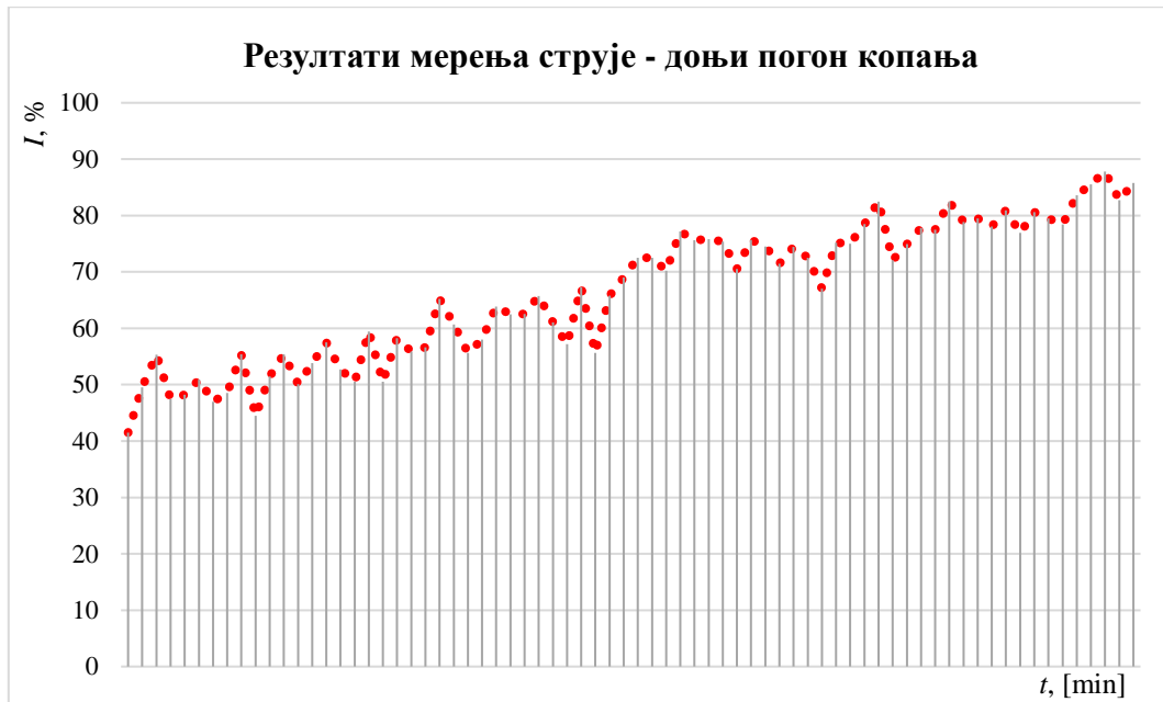
Слика 8.13. Струја коју доњи погон копања повлачи из мреже – похабаност 100 %
