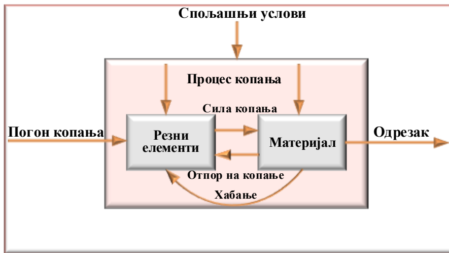
Слика 5.1. Блок шема процеса копања [81]
