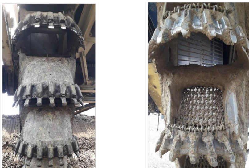
Слика 3.4. Изведбе ведрица: a – затворено дно; b – отворено дно са ланцима
