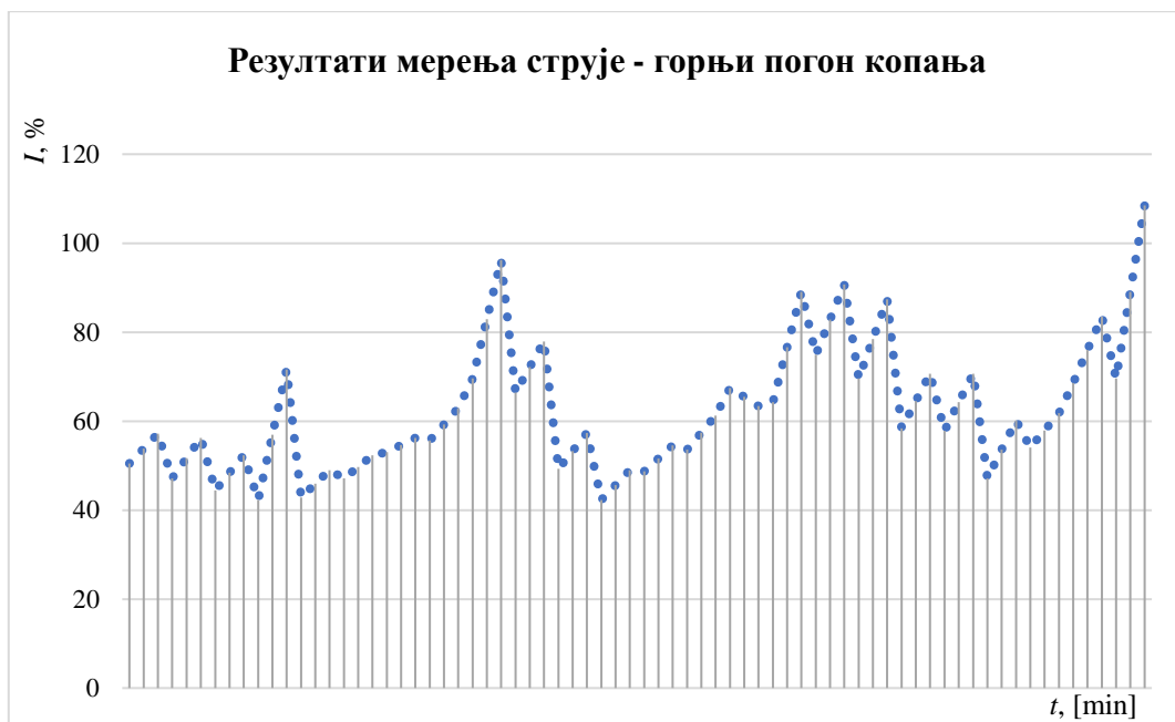
Слика 8.10. Струја коју горњи погон копања повлачи из мреже – похабаност 50 %
