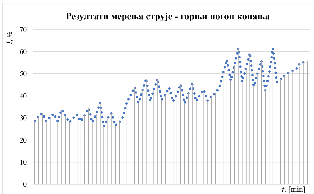
Слика 8.12. Струја коју горњи погон копања повлачи из мреже – похабаност 75 %
