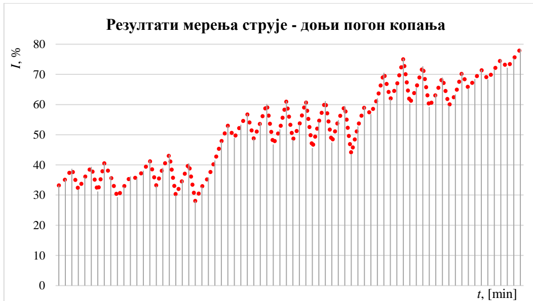
Слика 8.11. Струја коју доњи погон копања повлачи из мреже – похабаност 75 %
