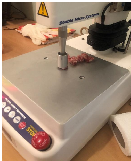
Slika 12. TPA test Njeguške kobasice (levo) i TA.XT analizator teksture (desno) ( https://prime.erpnext.com/ )
