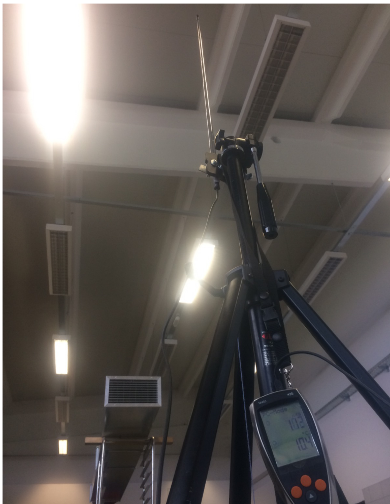
Слика 5.6. Мерење брзине струјања у млазу на вентилационој решетки
