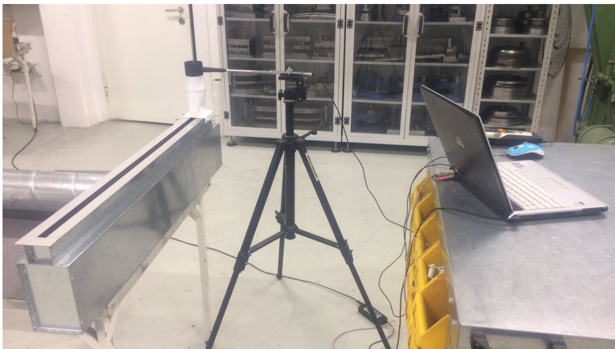
Слика 5.8. Мерење протока дуж отвора на линијском дифузору
