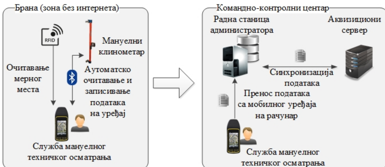
Слика 65. Унапређени модел система осматрања брана (фаза 2)
