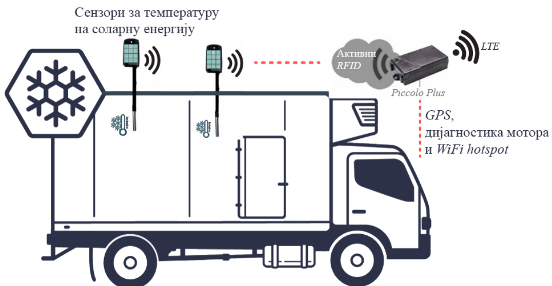
Слика 31. RFID GPS систем за праћење возила [105]
