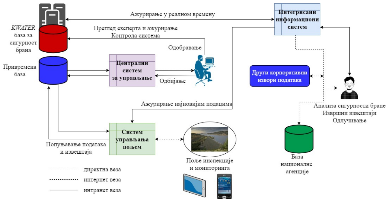
Слика 46. KDSMS систем мониторинга брана [44]
