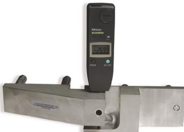
Слика 71. Компаратер Huggenberger ERDM25 [165]
