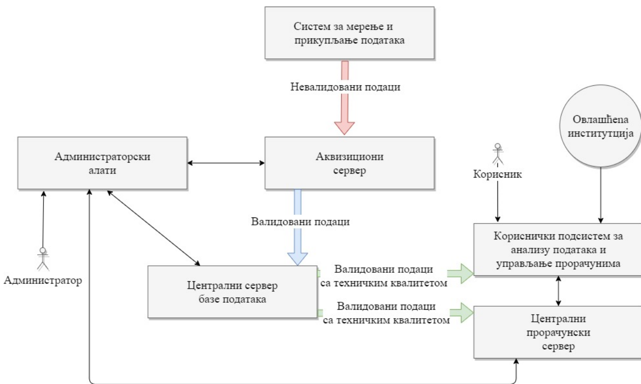
Слика 52. Структура модела система за управљање безбедношћу брана [159]
