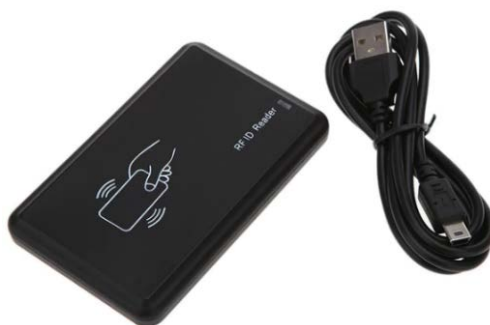
Слика 20. Фиксни RFID читач [89]
