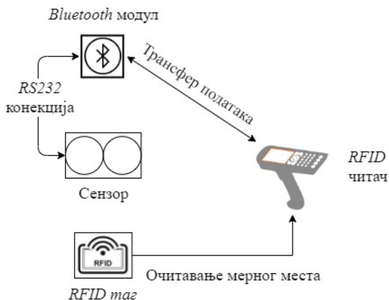
Слика 60. Концептуални модел комуникације између мерних уређаја и RFID технологије
