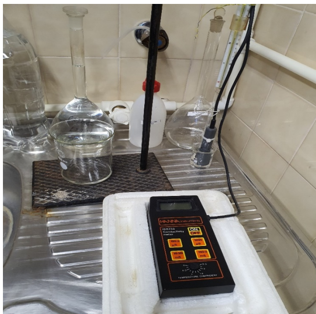
Slika 3.6. Hanna HI8733 uređaj za merenje električne konduktivnosti
