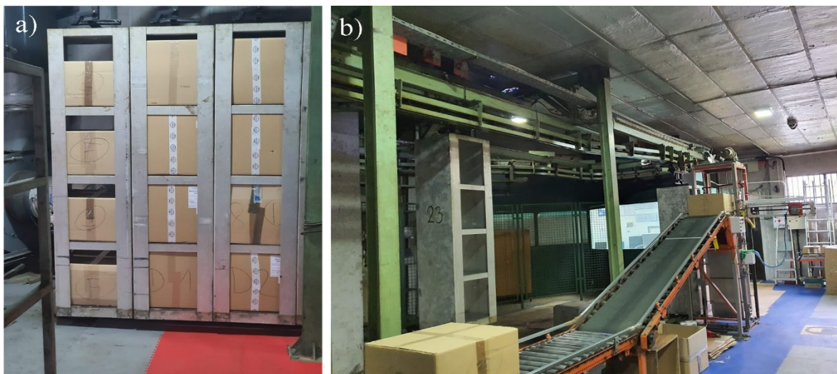
Slika 3.2. Kabine za ozračivanje (a) i transportni sistem (b) na Radijacionoj jedinici INN Vinča
