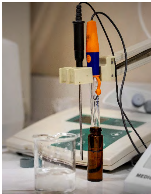
Slika 6. Merenje pH selektivnom elektrodom
