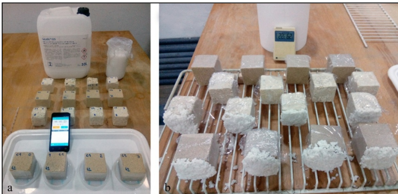
Sl. 36. Postupak konsolidacije prve grupe uzoraka: a) aplikacija konsolidanta C kapilarnim upijanjem; b) sušenje uzoraka u uslovima otkrivene i pokrivena površine evaporacije rastvarača
