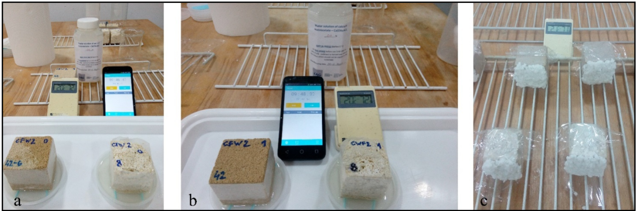
Sl. 37. Postupak konsolidacije prve grupe uzoraka: a) i b) aplikacija konsolidanta CFW kapilarnim upijanjem; b) sušenje uzoraka u uslovima pokrivena površine evaporacije rastvarača
