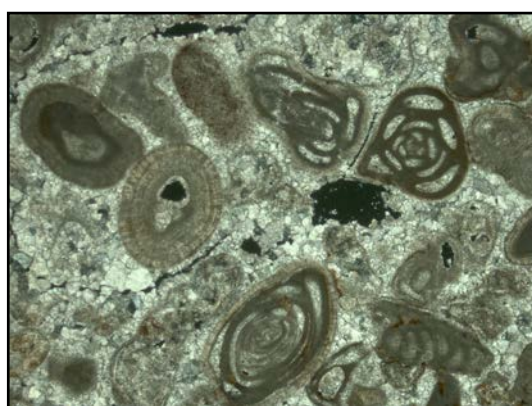
Sl. 48. Krupni kristali sparikalcita u uzorku oobiosparita (uzorak grainstone sa južne fasade Kralj kapije)
