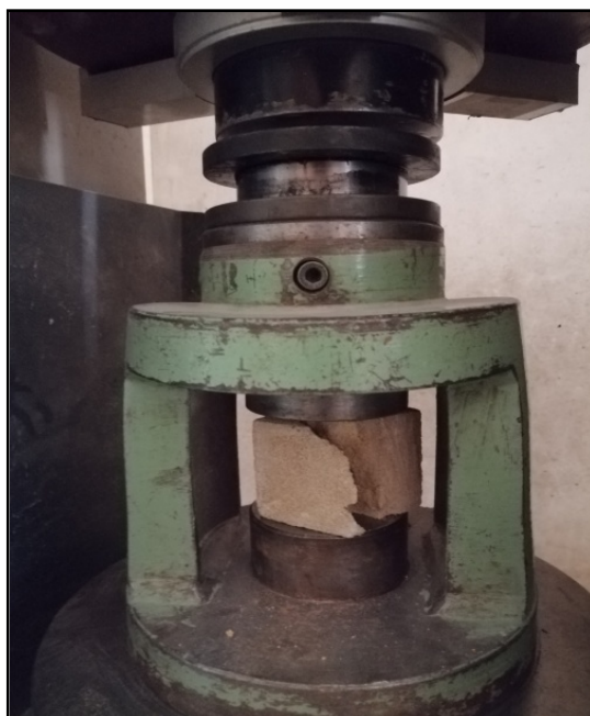
Sl. 32. Merenje čvrstoće pri pritisku kamena
