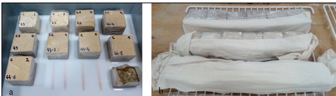
Sl. 39. Postupak konsolidacije druge grupe uzoraka: a) aplikacija konsolidanta C , b) sušenje uzoraka u uslovima u pokrivene površine evaporacije rastvarača
