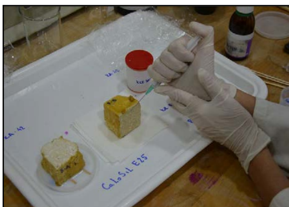
Sl. 34. Probna analiza u cilju definisanja načina i dužine trajanja aplikacije
