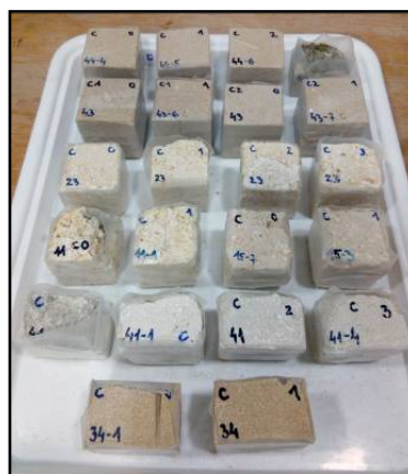
Sl. 35. Opitna tela pripremljena za tretman konsolidacije
