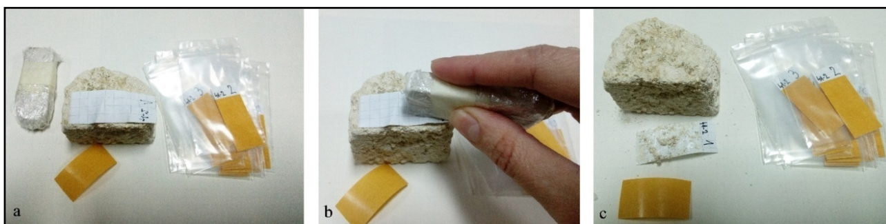
Sl. 29. Postupak ispitivanja: a) postavljanje test-trake; b) prljanje uz površinu gumicom za brisanje; c) uklanjanja test-trake sa dekoherentnim materijalom
