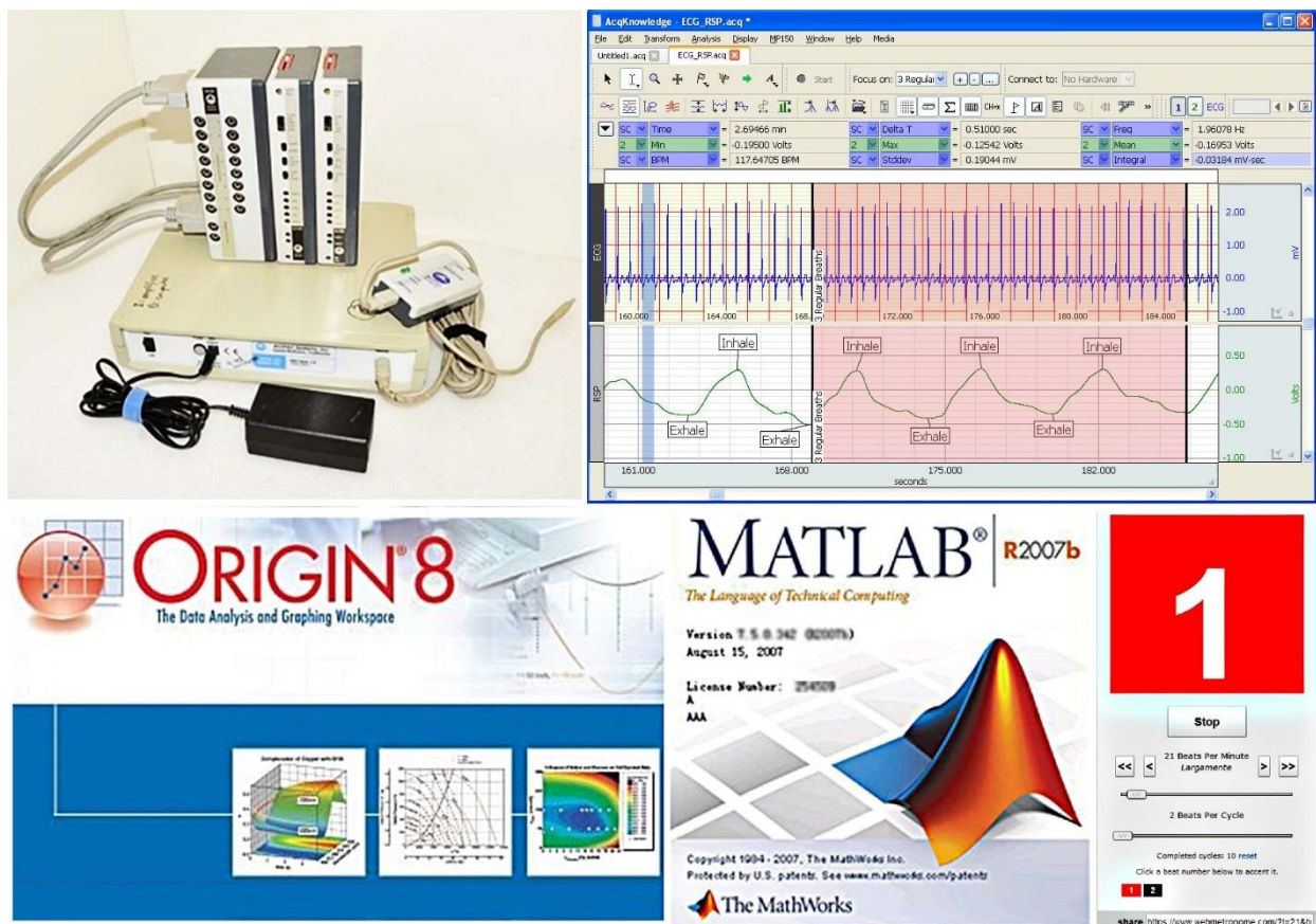
Слика 20: Алати за прикупљање и обраду података: горњи ред, с лева на десно- хардвер (MP100) и софтвер (AcqKnowledge® 3.91) система за снимање сигнала дисања и ЕКГ-а; доњи ред, с лева на десно) Origin® и Matlab® r2007b – софтвери за обраду и анализу података и метроном online софтвер за производњу звучног сигнала помоћу кога се вршило диктирање темпа успореног дисања.
